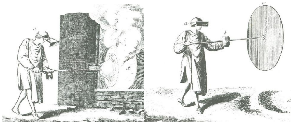
Ilustración 5. Fabricación vidrio plano (en discos o coronas) Fuente: KATHERINE K. LEITCH Structural Glass Technology: Systems and Applications (Recuperado 03 de Marzo 2015)
