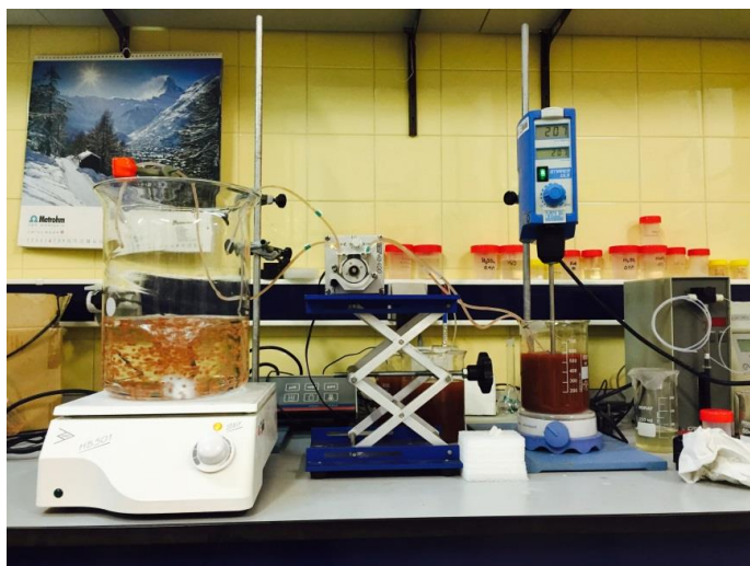
Figura 5. Montaje realizado para la preparación de perlas de quitosano y lodo rojo.
