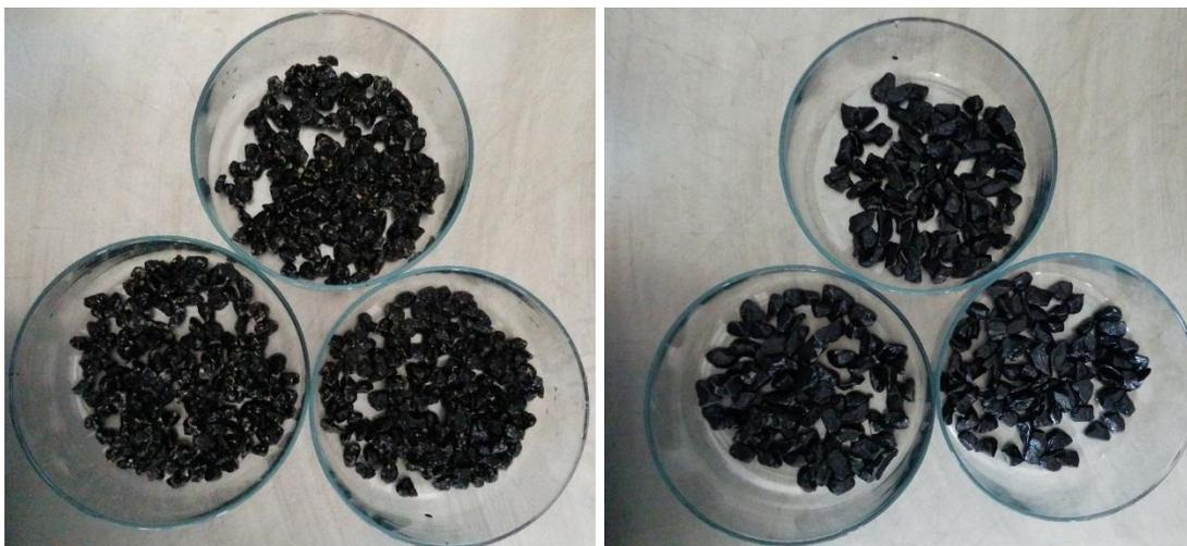
Figura 6.5 Comparativa de dos ensayos de botella giratoria con árido reciclado (izquierda) y árido natural (derecha)
