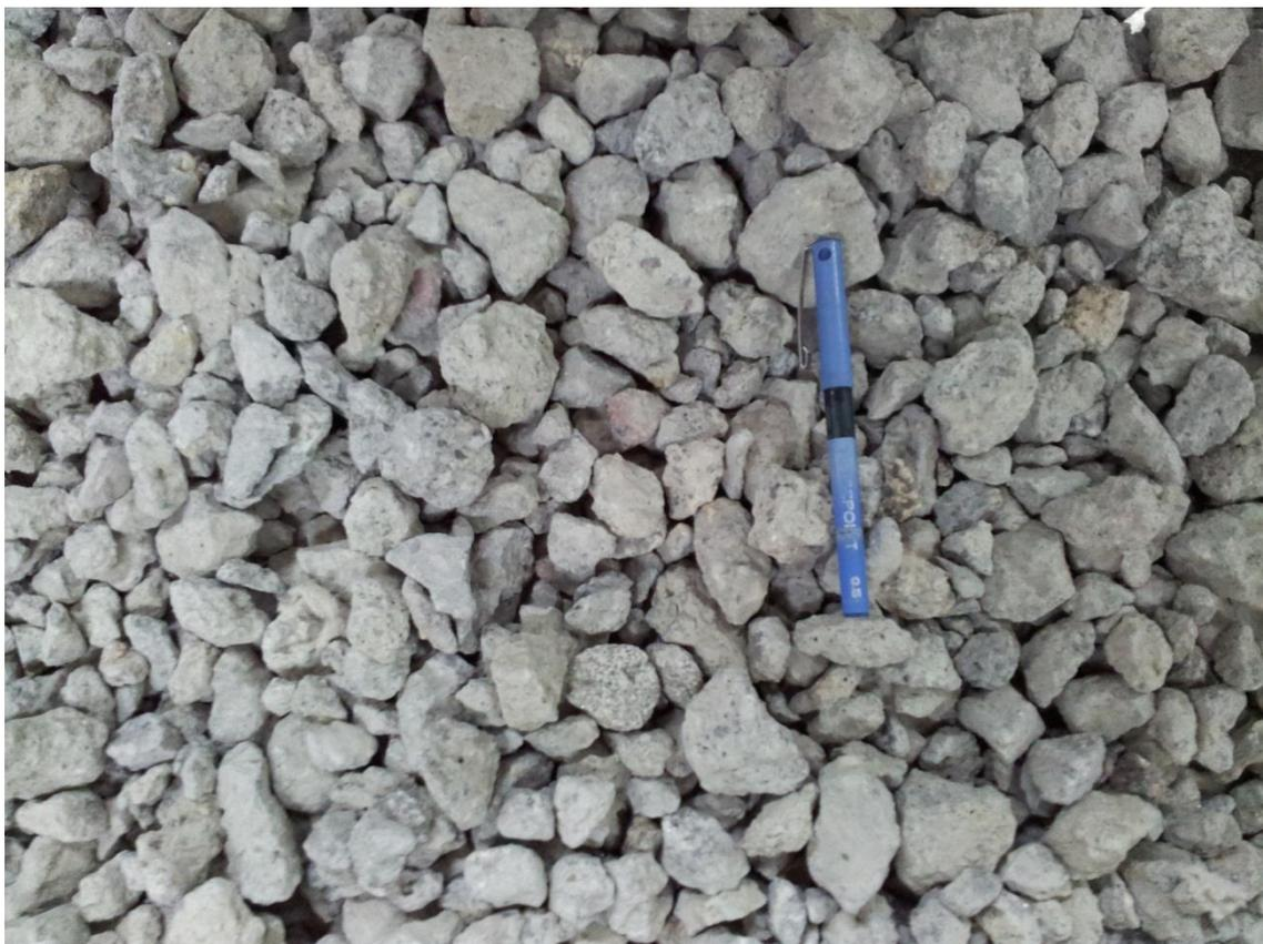
*Figura 4.6 Aspecto de la fracción gruesa (12/32 mm) del árido reciclado*
