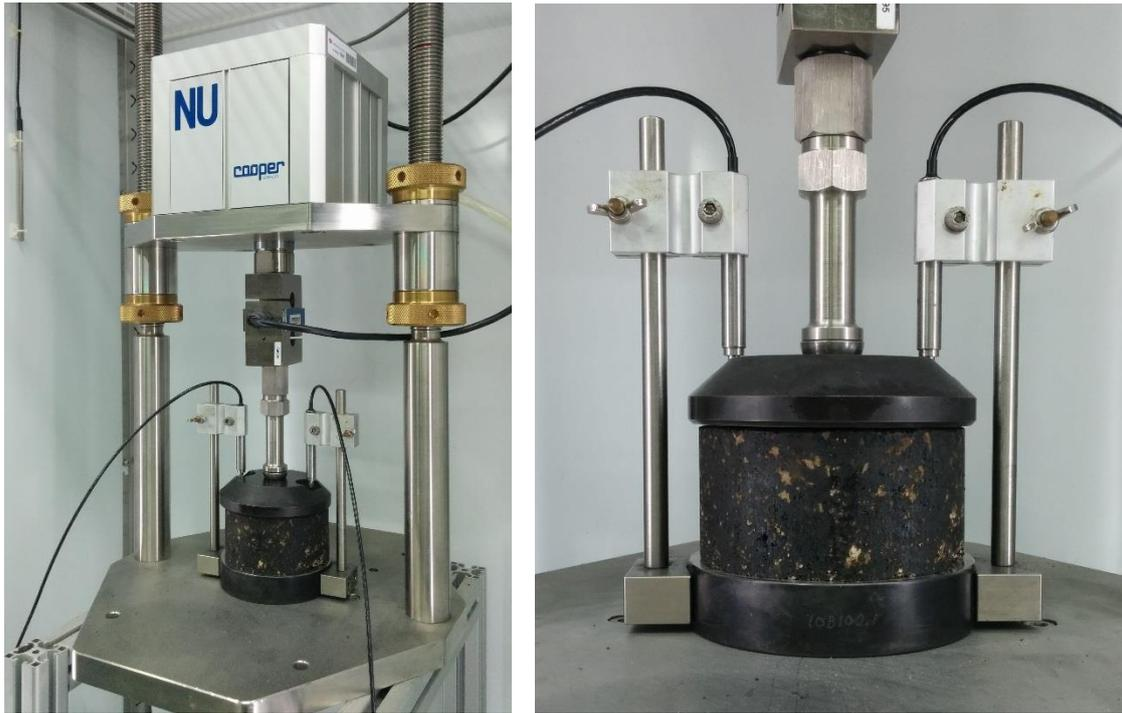
*Figura 7.27 Disposición del ensayo de deformación permanente según Norma BSi DD 226*
