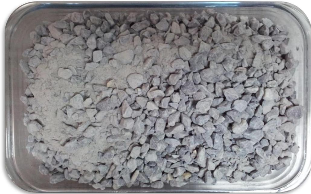
*Figura 4.34 Aspecto de una muestra de ensayo de árido natural tras ser sometida al test de Los Angeles*
