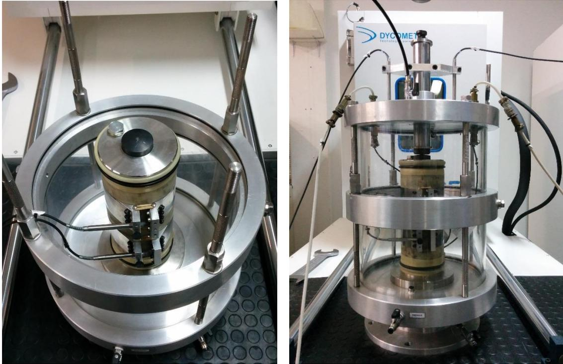
*Figura 8.1 Ensayo dinámico de rigidez con confinamiento triaxial según Norma UNE-EN 13286-7*
