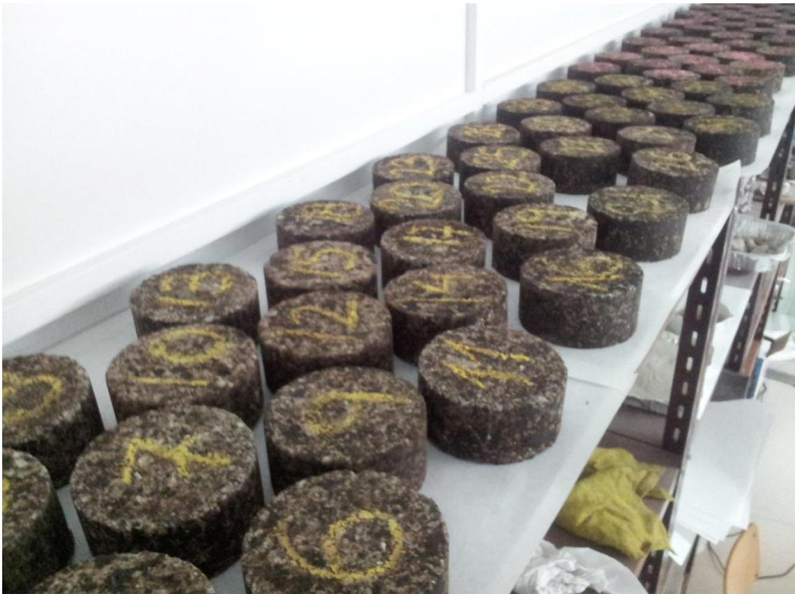
***Figura 7.12. Almacenamiento de probetas durante periodo de curado***
