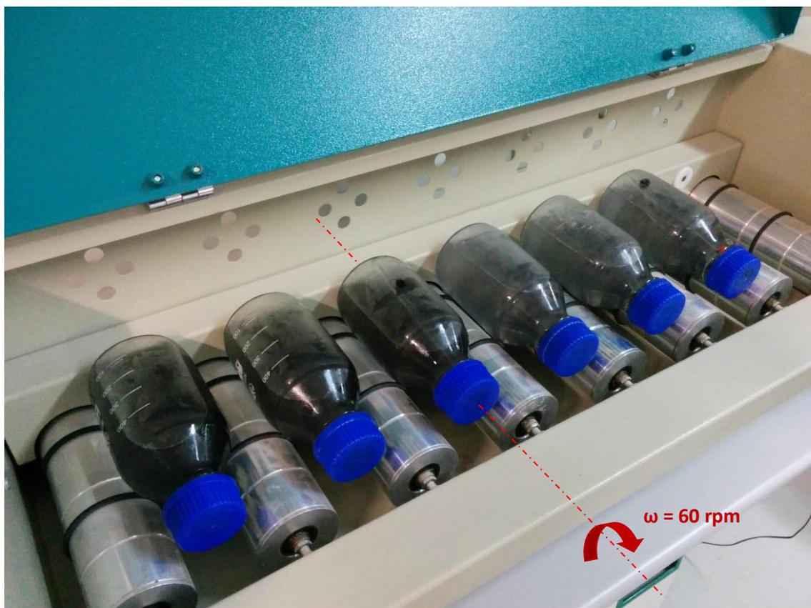
*Figura 6.1 Disposición de las botellas con 2 muestras diferentes (3 sub-muestras cada una) en el ensayo de la botella giratoria*
