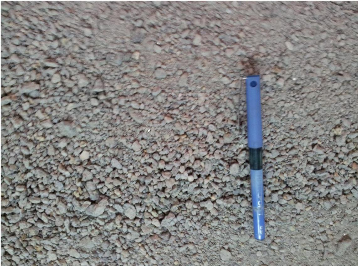
*Figura 4.4 Aspecto de la fracción fina (0/6 mm) del árido reciclado*
