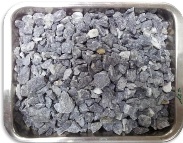
*Figura 4.1 Aspecto de la fracción 16/32 mm del árido natural*
