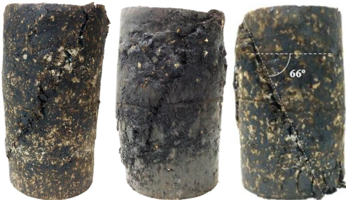
*Figura 8.7 Ejemplos de probetas rotas tras ensayo triaxial de deformación permanente*
