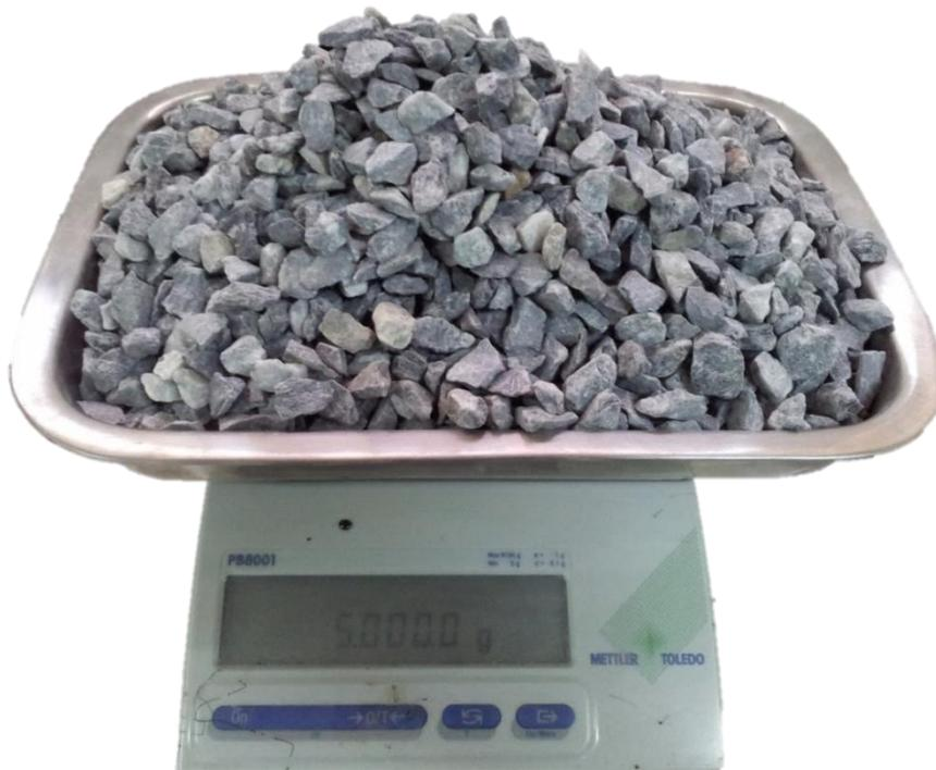
*Figura 4.33 Aspecto de una muestra de ensayo de árido natural antes de ser sometida al test de Los Angeles*
