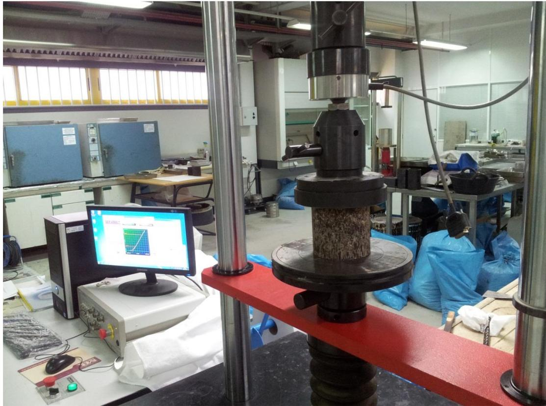
*Figura 6.6 Rotura de probetas a compresión simple según Norma NLT-161/98*
