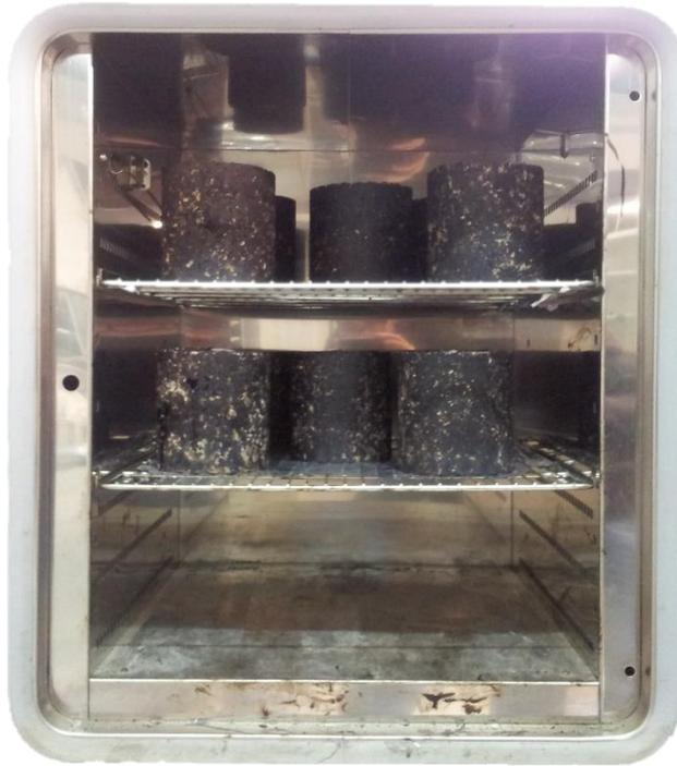
*Figura 5.5 Curado de probetas en estufa a 50°C durante 3 días según Pliegos ATEB*
