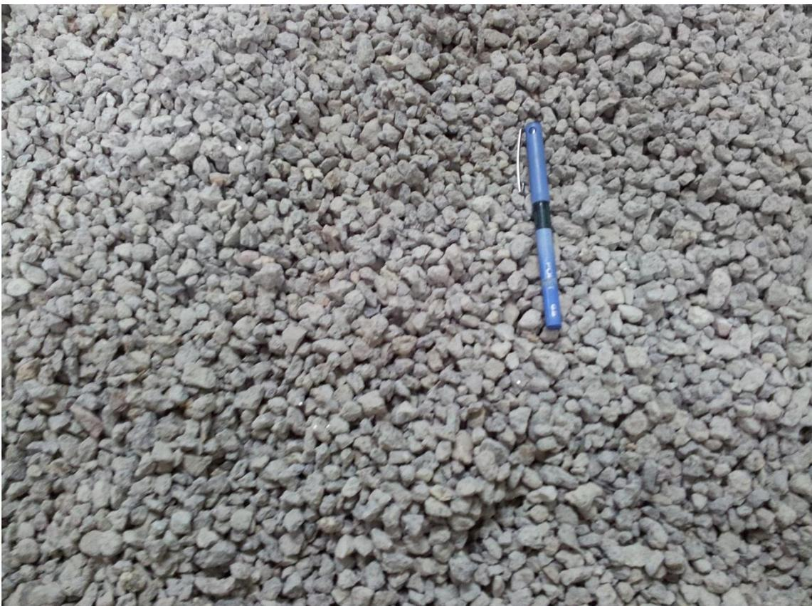
*Figura 4.5 Aspecto de la fracción media (6/12 mm) del árido reciclado*
