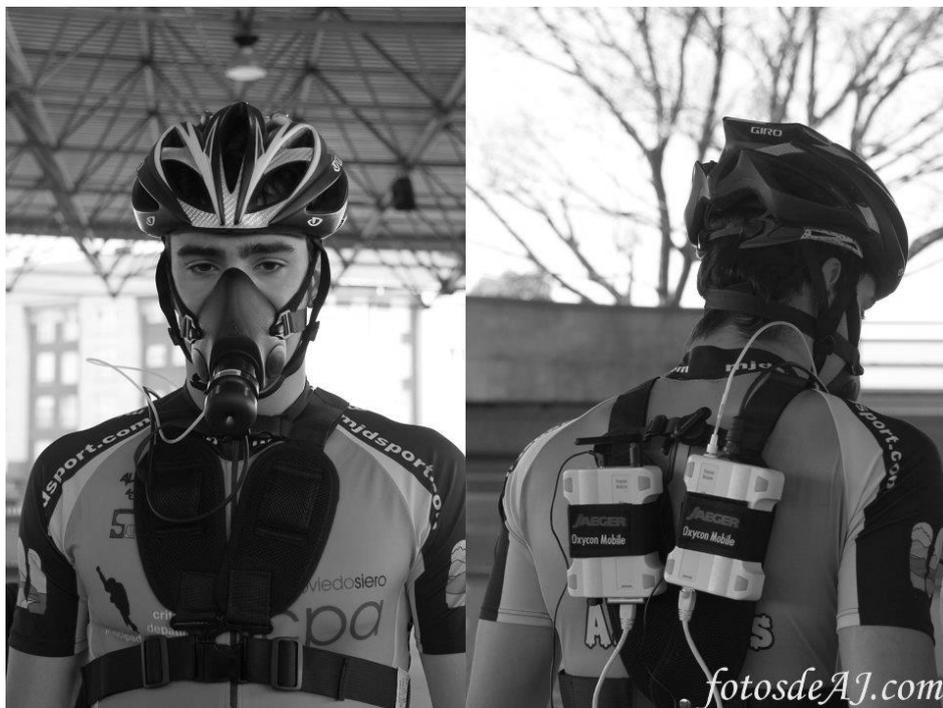
Fig. 3.2.3. Imagen Ergoespirómetro Portátil Jaeger Oxycon Mobile.
