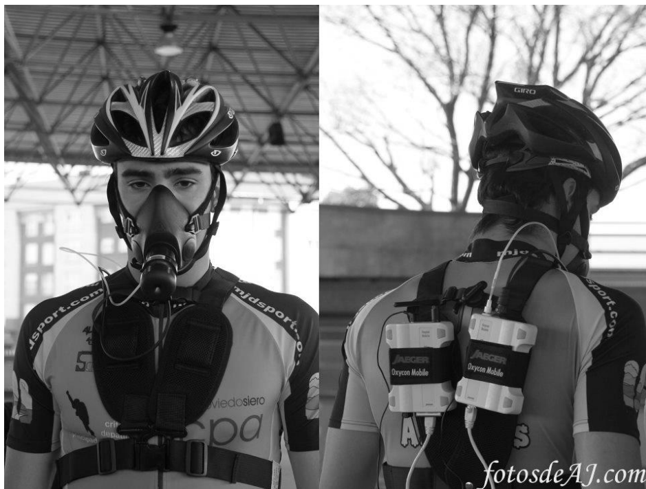
Fig. 3.2.3. Imagen Ergoespirómetro Portátil Jaeger Oxycon Mobile.
