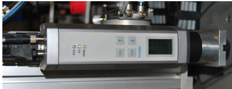
Figura 2.2.7.4.2.1 - Panel de control del servomotor rotativo
