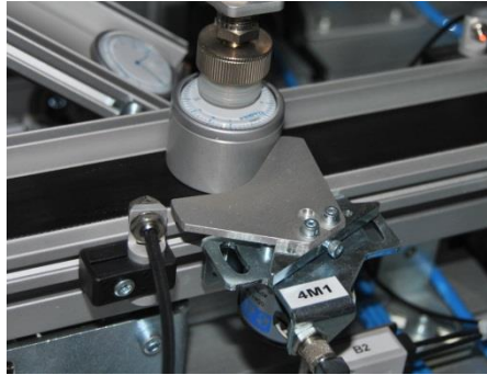
Figura 2.2.4.2.1.2 - Robot incrustando la cabeza del reloj en la culata
