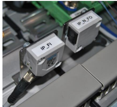
Figura 2.4.2.1 - Fotocélula receptora y emisora de dos estaciones
