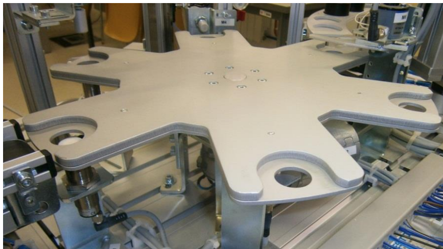
Figura 2.2.6.2.1.1 - Mesa giratoria de indexación
