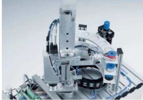
Figura 1.3.7 - Estación de almacenamiento
