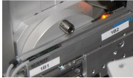
Figura 2.2.7.3.2.1 - Finales de carrera magnéticos
