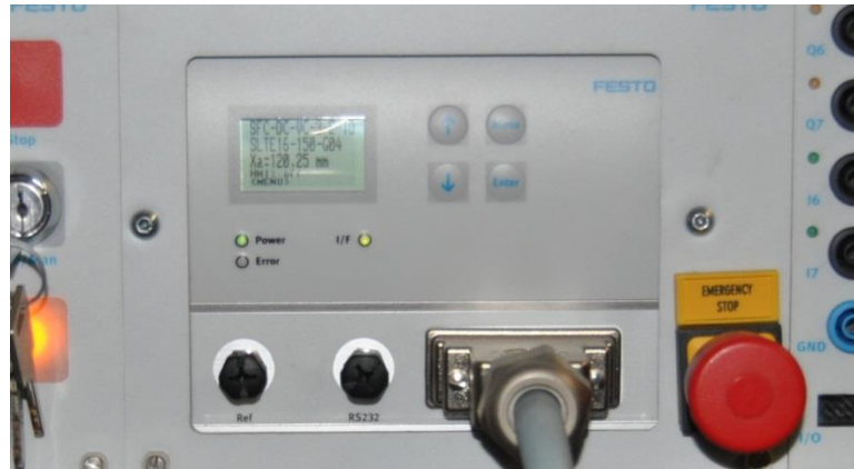
Figura 2.2.7.4.1.1 - Panel de control del servomotor lineal
