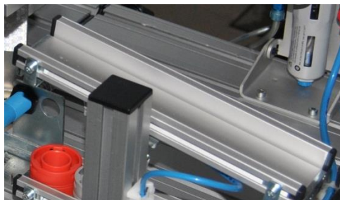
Figura 2.2.2.4.2.1 - Rampa de aire
