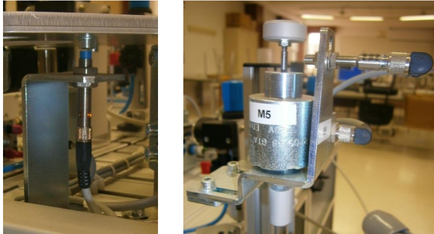
Figura 2.2.6.3.3.1 - Sensor de proximidad inductivo
