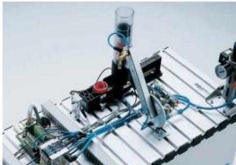
Figura 1.3.1 - Estación de distribución
