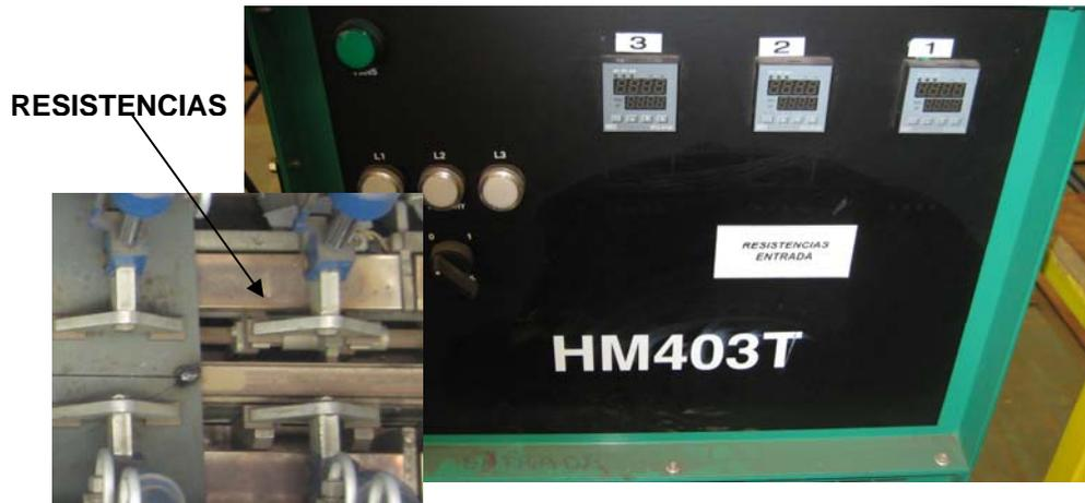
Figura 1.9.2.3.5 – Controladores y resistencias de precalentamiento.
