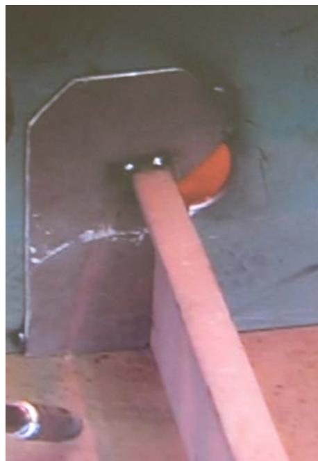
Figura 1.8.6.2 – Foto de un tipo de paso de longitudinal
