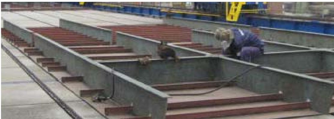
Figura 1.8.5.1 – Unidad abierta con previas incorporadas.
