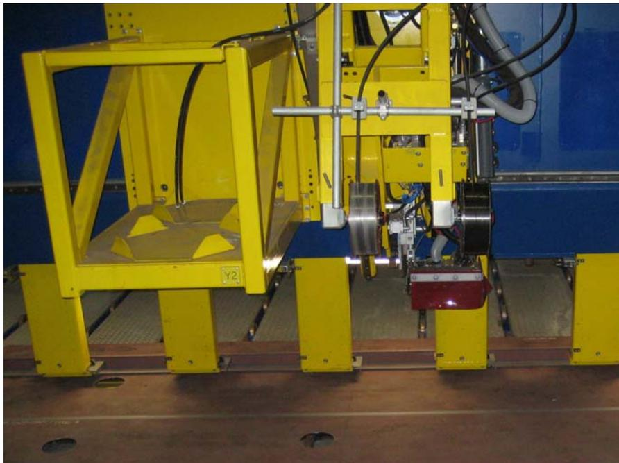
Figura 1.8.4.2.1 – Estación de incorporación y soldadura de refuerzos longitudinales.
