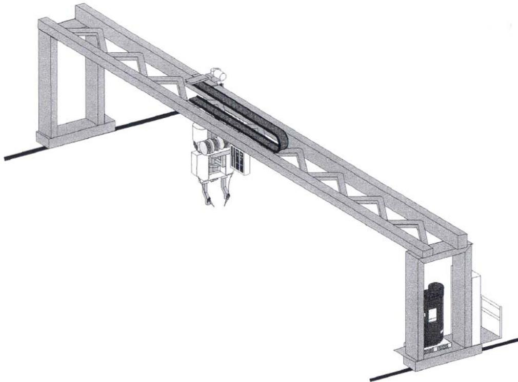
Figura 1.8.4.1.1.1- Estación independiente de soldadura de longitudinales.
