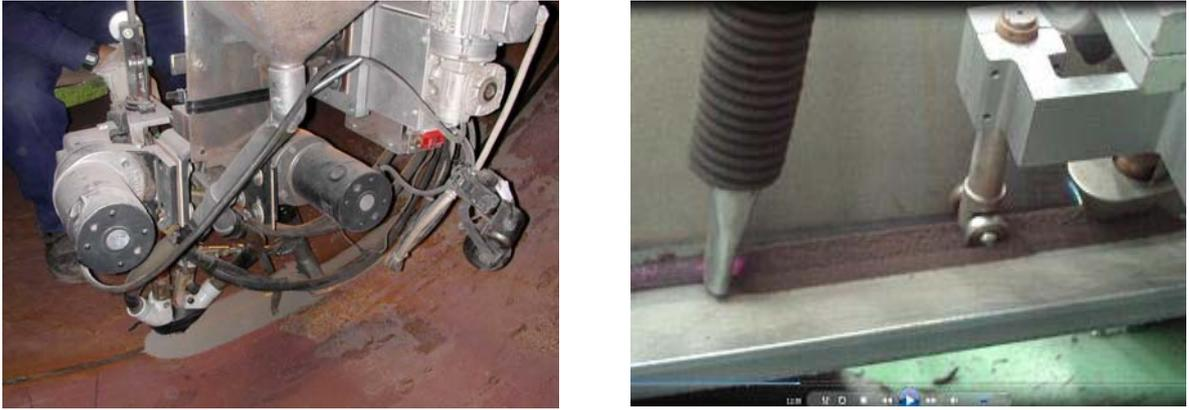
Figura 1.8.1.1.2- Ejemplos reales de aplicación de proceso de soldadura SAW.
