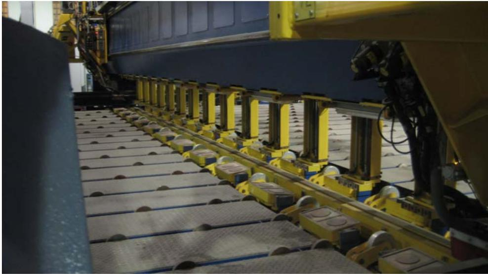
Figura 1.8.4.4.1 – SMWP (Incorporador automático de perfiles)
