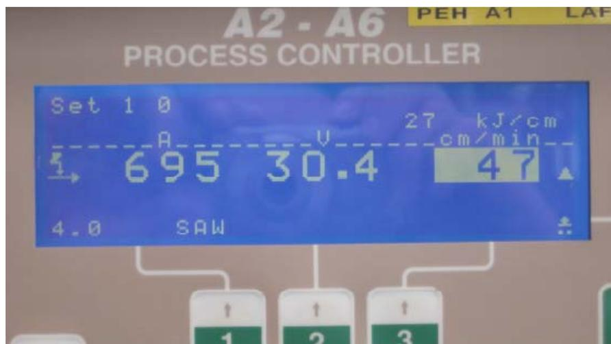
Figura 1.9.2.3.4 – Control de parámetros de soldadura.
