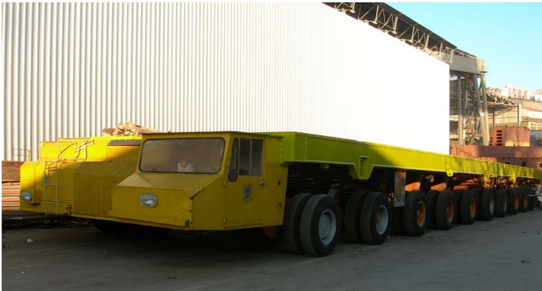
Figura 1.8.8.1 – Unidad de carga convencional de un astillero.
