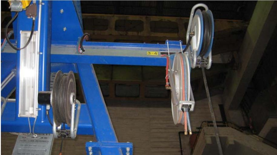
Figura 1.8.3.1 – Alimentadores de gases, aire y corriente (220V)
