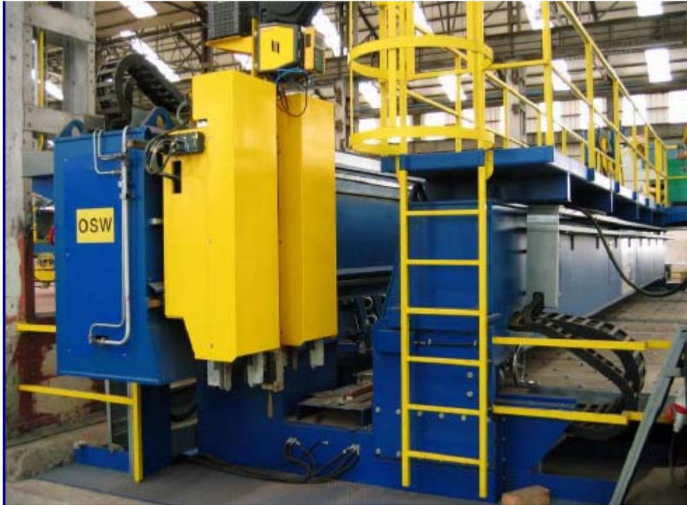
Figura 1.8.1.3.3- Estación de soldadura de chapas por una cara. (OSW)
