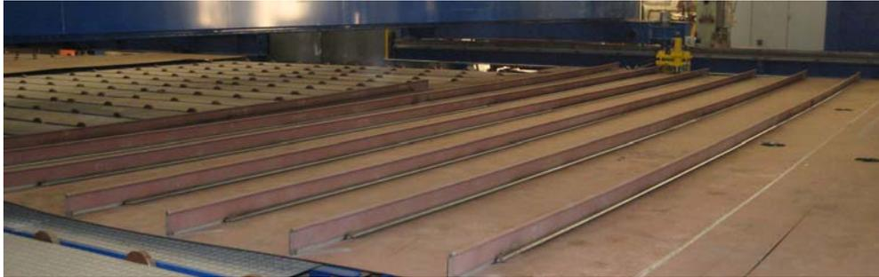
Figura 1.8.4.1 – Panel con longitudinales incorporados.
