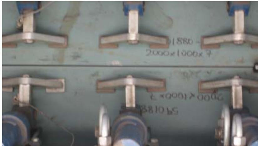
Figura 1.9.2.3.3 – Sujeción y alineación de chapas
