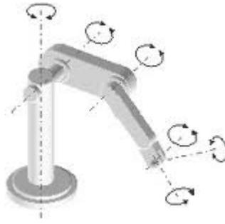
Figura 1.9.7.1 - Robot con 6 grados de libertad.
