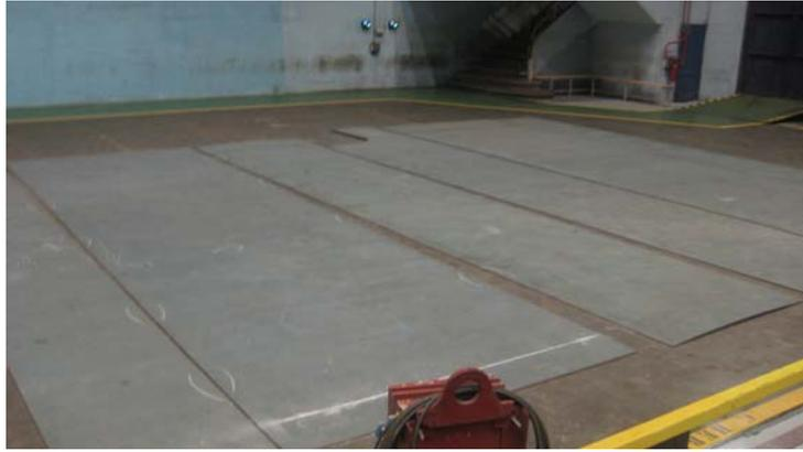
Figura 1.8.1.1 – Proceso de unión de chapas convencional.
