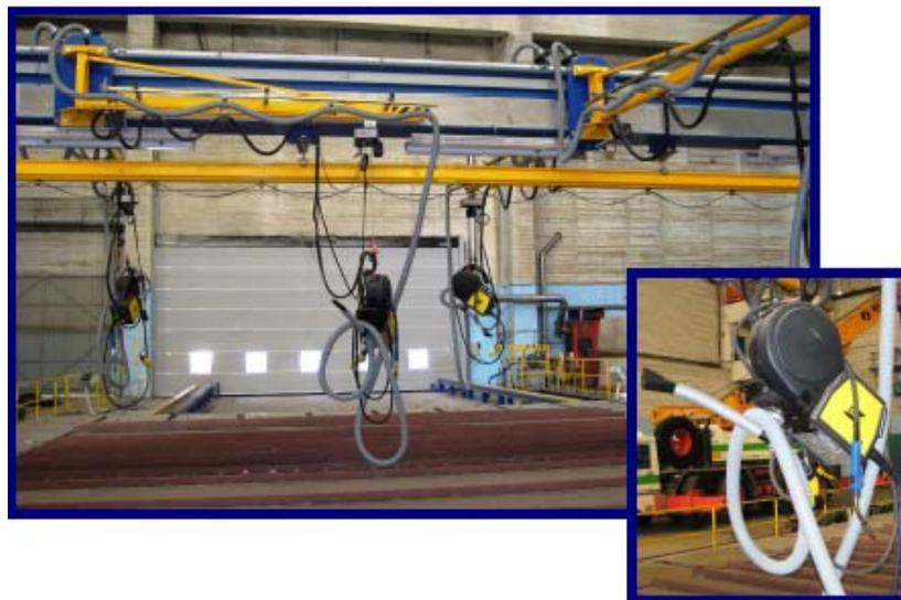
Figura 1.9.8.2.1- Alimentadores de soldadura colgados sobre el pórtico.
