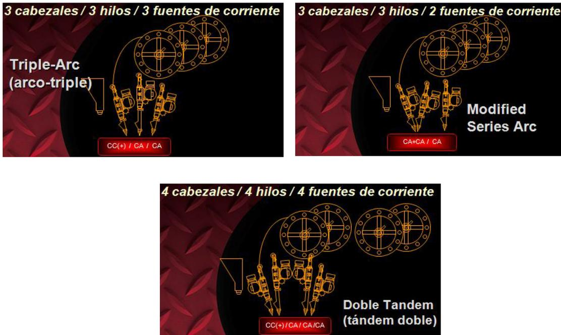
Figura 1.8.1.2.1- Variables multielectrodos SAW.
