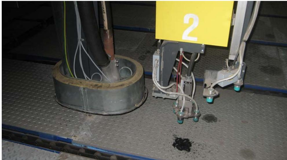
Figura 1.8.3.2 – Herramienta de marcado y chorreado de una estación.
