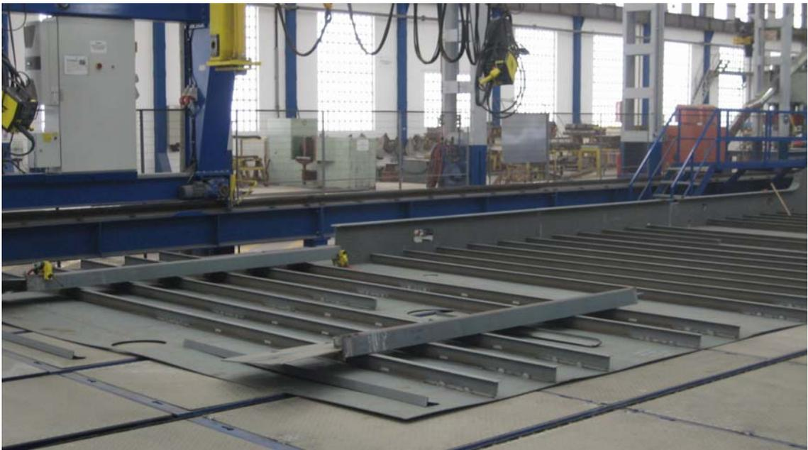
Figura 1.2.2- Fabricación en Línea de una “Unidad Abierta”
