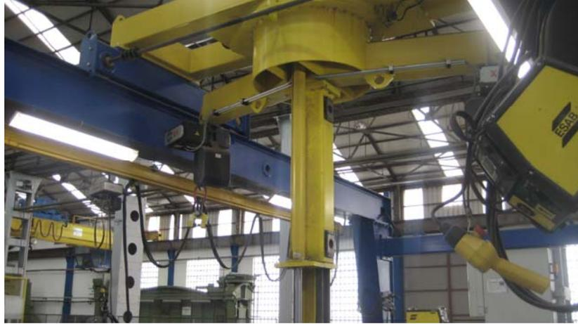
Figura 1.8.5.2 – Dispositivo de giro en pórtico.
