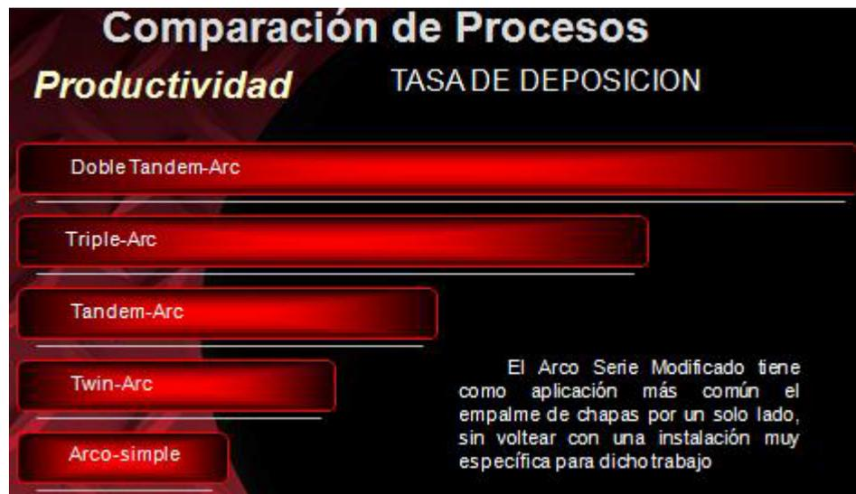
Figura 1.8.1.2.2-Comparativa de procesos SAW (tasa de deposición).
