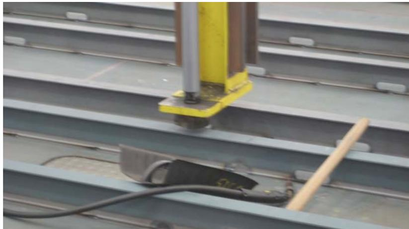
Figura 1.8.5.3 – Prensa neumática de auxilio al armado.
