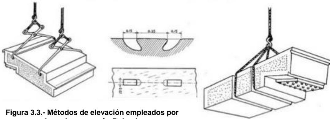
Figura 3.3.- Métodos de elevación empleados por los griegos, según Roland.
