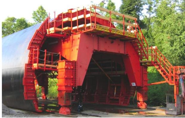
**Figura 6.30e.- Carro de encofrado para túneles con seguridad integrada.**
