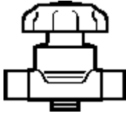
Figura 1.11.2.1 – Figura de la válvula de cierre Danfoss BMSL 10
