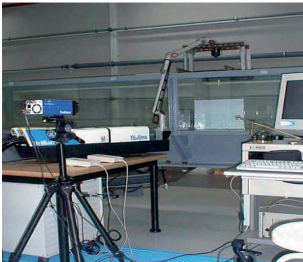
Figura 5.3. Equipo PIV situado en el canal.
