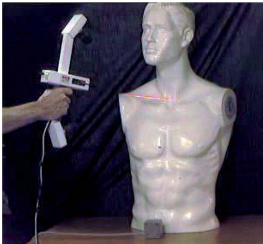
Figura 3.4. Forma de utilización de la pistola del Polhemus FastScan.
