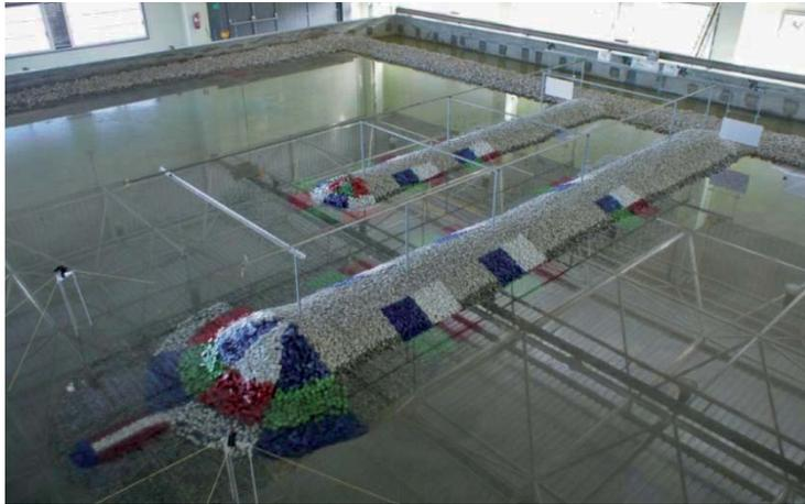
Figura 5.11. Modelo a escala del contradique y espigón en el tanque de oleaje.
