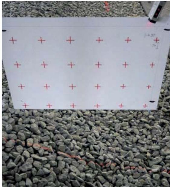
Figura 3.70. Imagen tomada por la cámara mostrando el patrón y la línea proyectada por el láser.
