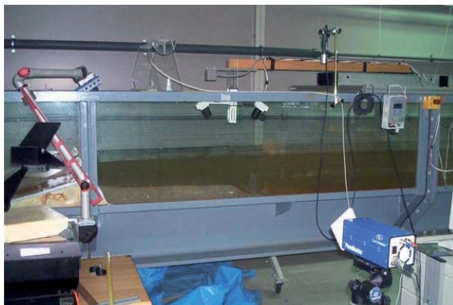
Figura 1.18. Uso acoplado del escáner 3D y el PIV en un estudio de erosión.
