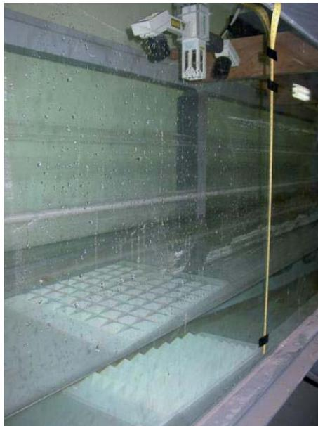
Figura 3.55. Patrón de calibración bajo una lámina de agua.
