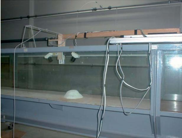
Figura 5.2. Estructura de soporte y traslación del escáner 3D sobre el canal.
