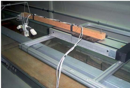
Figura 3.17. Bastidor robotizado para el desplazamiento del escáner.
