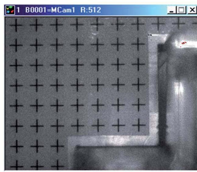
Figura 3.63. Patrón de calibración del PIV.
