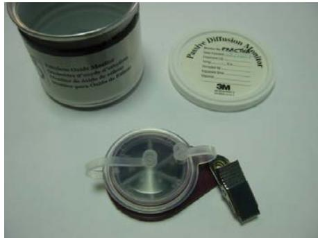
Figura A.5. Muestreador pasivo para OEt, 3M 3550
