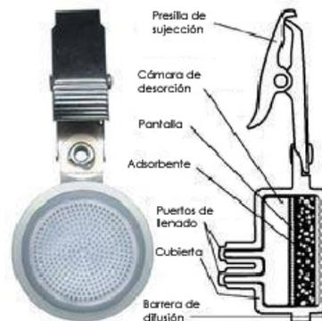
Figura A.3. Esquema de monitores pasivos SKC (Cortesía de SKC)
