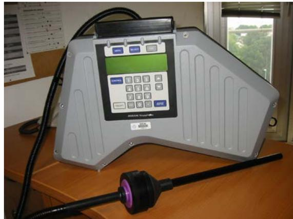
Figura A.2. Analizador de IR MIRAN SaphiRe
