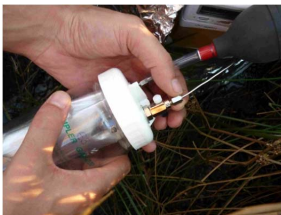
Foto 2-8: Enganche de la conducción a la botella de gases.
