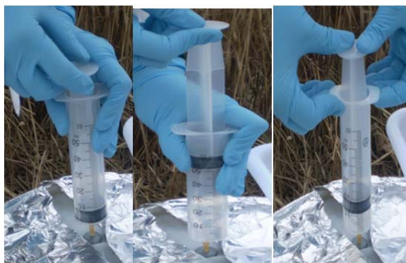
Figura 2-9: Homogeneización previa a la toma de muestra a través del septum y captación de la misma.
