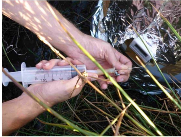
Foto 2-2: Eliminación de la condensación en la conducción de extracción del gas.
