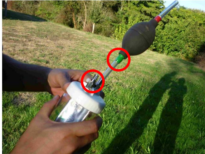
Foto 2-4: Colocación de la pera extractora y apertura de la válvula de salida de gas.
