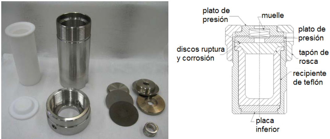
Figura 1. Distintas partes de un autoclave y montaje
