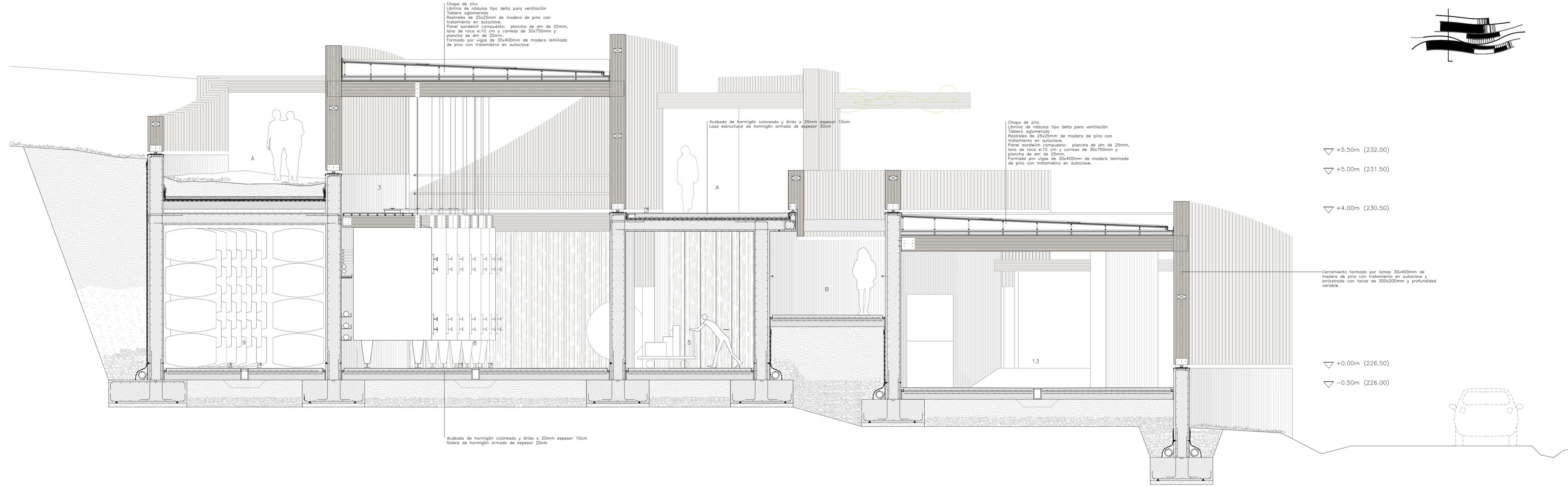
1. VESTIBULO SUPERIOR 2. LABORATORIOS 3. PASADIZO SOBRE CUBAS 4. VESTIBULO INFERIOR 5. ZONA DE ALMACENAJE GENERAL 6. TALLER MANTENIMIENTO 1 7. TALLER MANTENIMIENTO 2 8. ZONA DE ELABORACIÓN Y CUBAS DE ACERO 9. ZONA ALMACENAJE EN BARRICA 10. CENTRAL DE FRIO Y INSTALACIONES 11. RAMPA Y ZONA DE PASO 12. GARAJES MAQUINARIA Y COCHES 13. DISTRIBUCIÓN Y EMBOTELLADO 14. CAVA DE VINDOS 15. SALA DE CATAS 16. ASESOS COMUNES 17. VESTUARIOS PERSONAL
