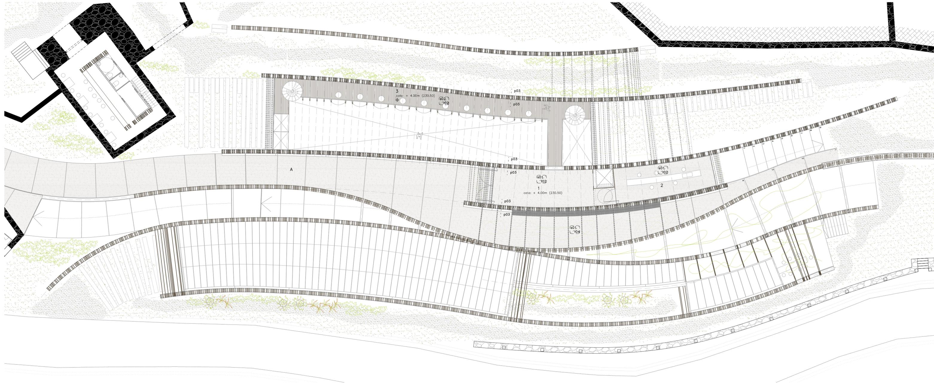
1. VESTIBULO SUPERIOR 2. LABORATORIOS 3. PASADIZO SOBRE CUBAS 4. VESTIBULO INFERIOR 5. ZONA DE ALMACENAJE GENERAL 6. TALLER MANTENIMIENTO 1 7. TALLER MANTENIMIENTO 2 8. ZONA DE ELABORACIÓN Y CUBAS DE ACERO 9. ZONA ALMACENAJE EN BARRICA 10. CENTRAL DE FRIO Y INSTALACIONES 11. RAMPA Y ZONA DE PASO 12. GARAJES MAQUINARIA Y COCHES 13. DISTRIBUCIÓN Y EMBOTELLADO 14. CAVA DE VINOS 15. SALA DE CATAS 16. ASEOS COMUNES 17. VESTUARIOS PERSONAL
