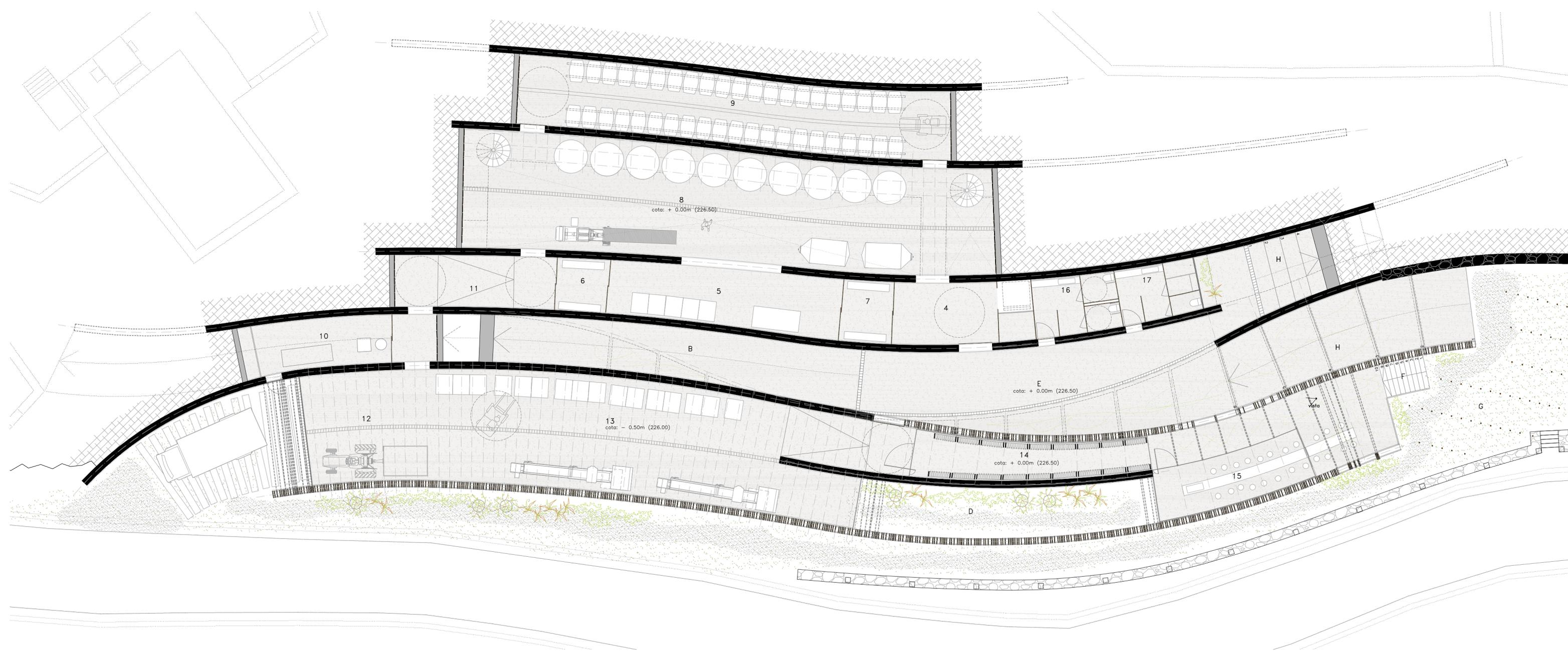
1. VESTIBULO SUPERIOR 2. LABORATORIOS 3. PASADIZO SOBRE CUBAS 4. VESTIBULO INFERIOR 5. ZONA DE ALMACENAJE GENERAL 6. TALLER MANTENIMIENTO 1 7. TALLER MANTENIMIENTO 2 8. ZONA DE ELABORACIÓN Y CUBAS DE ACERO 9. ZONA ALMACENAJE EN BARRICA 10. CENTRAL DE FRIO Y INSTALACIONES 11. RAMPA Y ZONA DE PASO 12. GARAJES MAQUINARIA Y COCHES 13. DISTRIBUCIÓN Y EMBOTELLADO 14. CAVA DE VINOS 15. SALA DE CATAS 16. ASESOS COMUNES 17. VESTUARIOS PERSONAL
