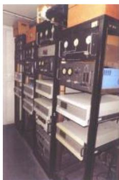
Imagen 3. Analizadores de gases en continuo para SO<sub>2</sub> y NO<sub>x</sub>.
