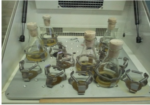
Figura 3. 4.-Shaker con matraces en agitación. (250 rpm y 37°C).
