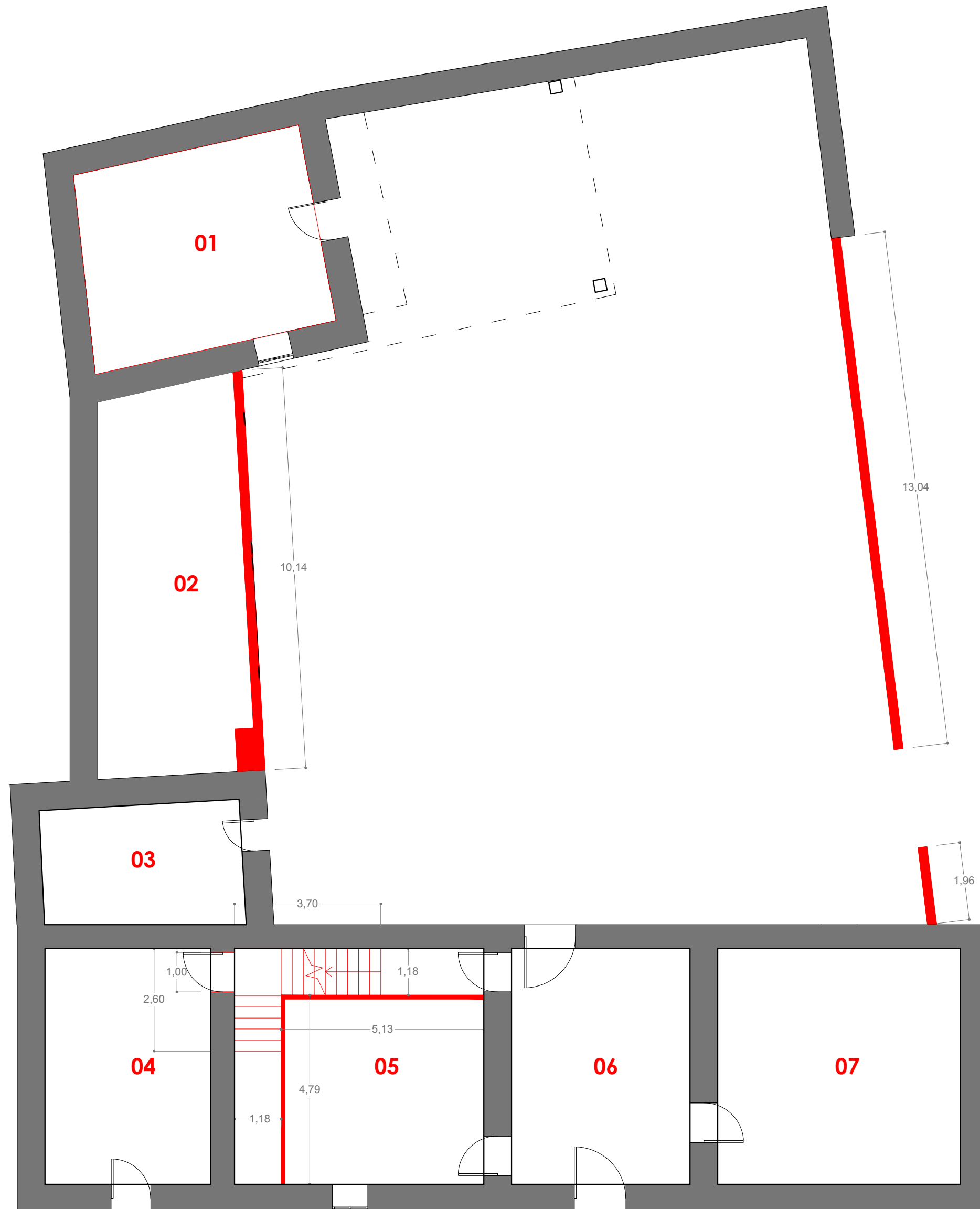
PLANTA BAJA DEMOLICIÓN
