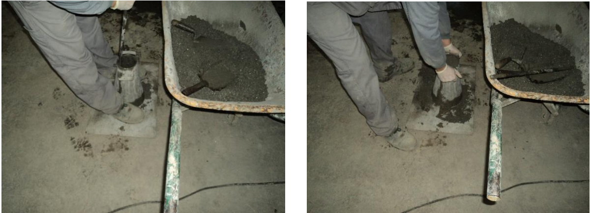
Ilustración 7.1. Ilustración 7.2. Ensayo de asentamiento del cono de Abrams.
