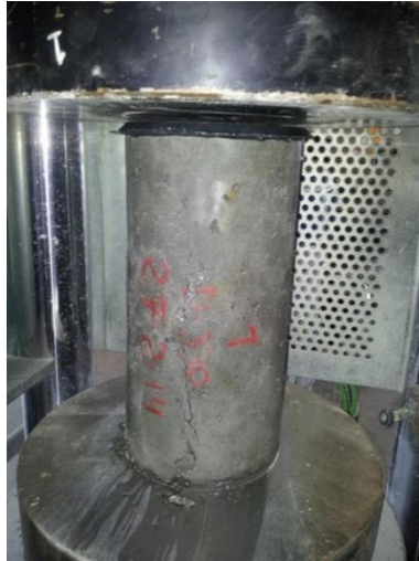
Ilustración 5.1. Probeta sometida al ensayo de resistencia a compresión.
