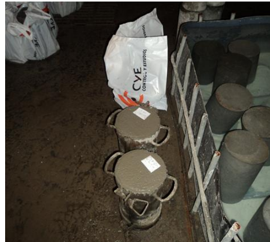
Ilustración 7.21. Ilustración 7.22. Fabricación y curado de probetas.
