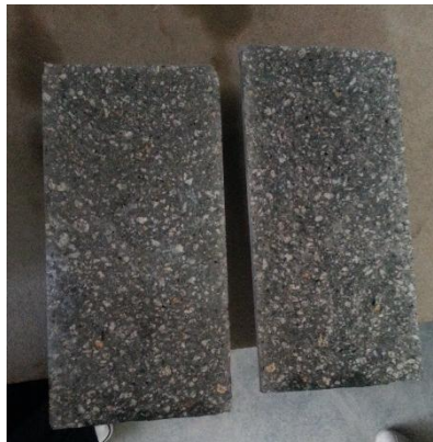
Ilustración 5.2. Probeta sometida a ensayo de penetración de agua bajo presión.
