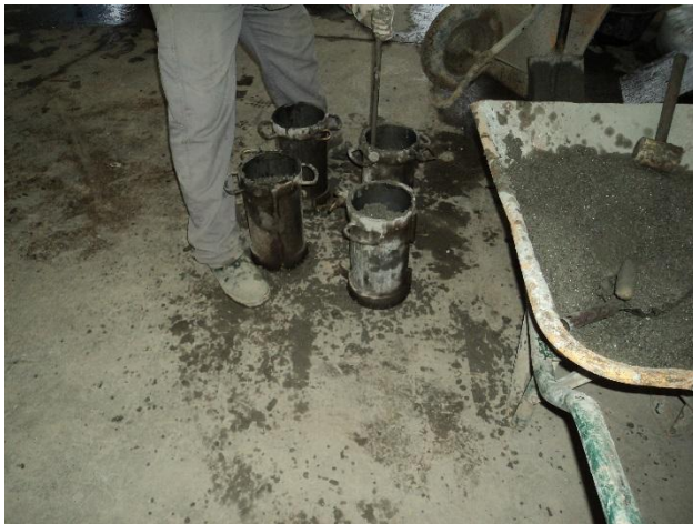
Ilustración 7.21. Ilustración 7.22. Fabricación y curado de probetas.
