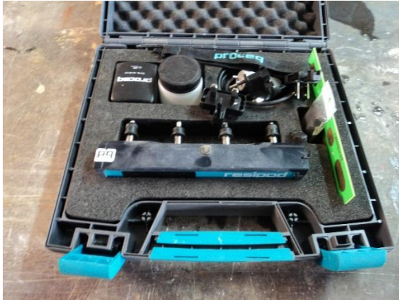
Ilustración 7.6. Ilustración 7.7. Resistivímetro tipo Wenner utilizado.
