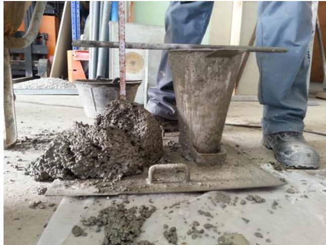
Ilustración 7.5. Asentamiento no válido.
