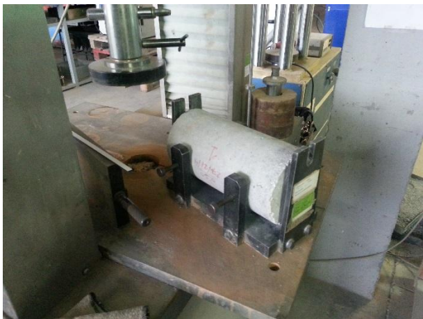
Ilustración 7.12. Ilustración 7.13. Rotura de probetas para ensayo de penetración de agua a presión.
