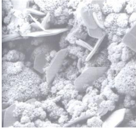
Ilustración 2.2. Pasta de cemento hidratada: Ca(OH) 2 y C-S-H
