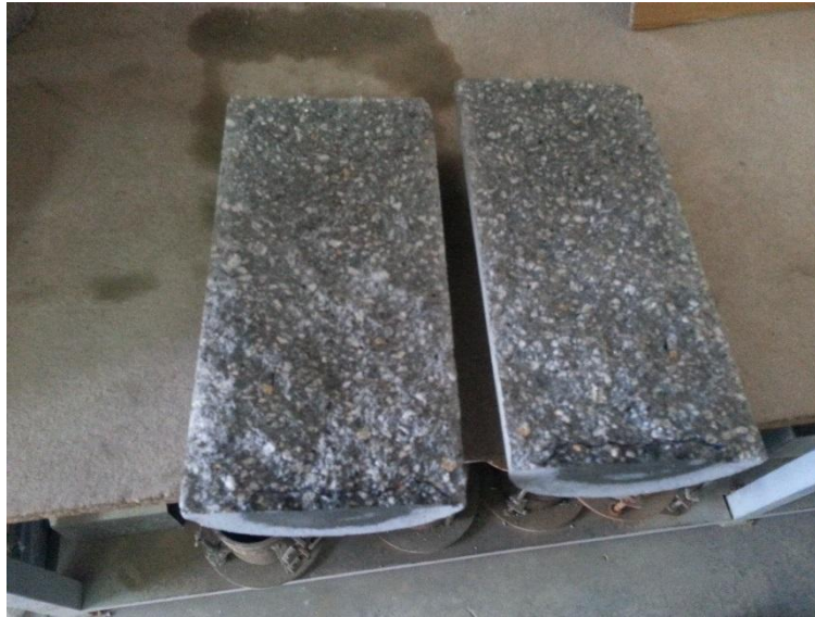
Ilustración 7.14. Profundidad de penetración de agua en las probetas ensayadas.
