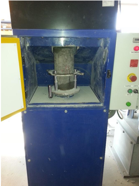
Ilustración 7.15. Ilustración 7.16. Rotura de probetas a compresión.
