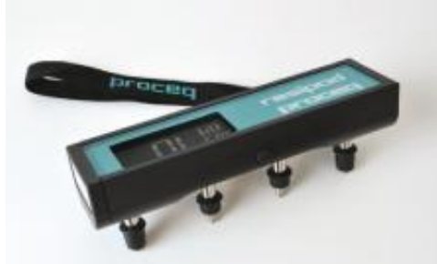
Ilustración 5.6. Resistivímetro tipo Wenner.
