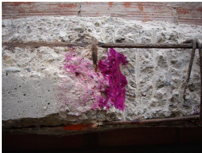
Ilustración 3.8. Utilización de indicadores de pH.
