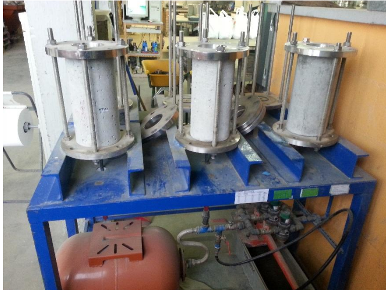
Ilustración 7.11. Probetas sometidas a ensayo de penetración de agua a presión.
