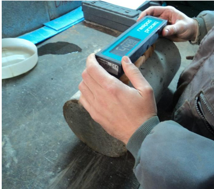
Ilustración 7.10. Medición de resistividad con aparato tipo Wenner.
