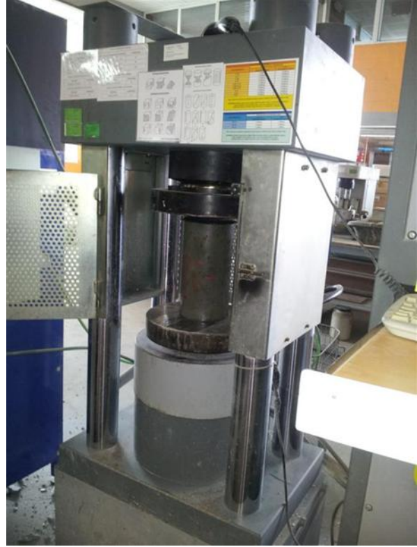
Ilustración 7.15. Ilustración 7.16. Rotura de probetas a compresión.
