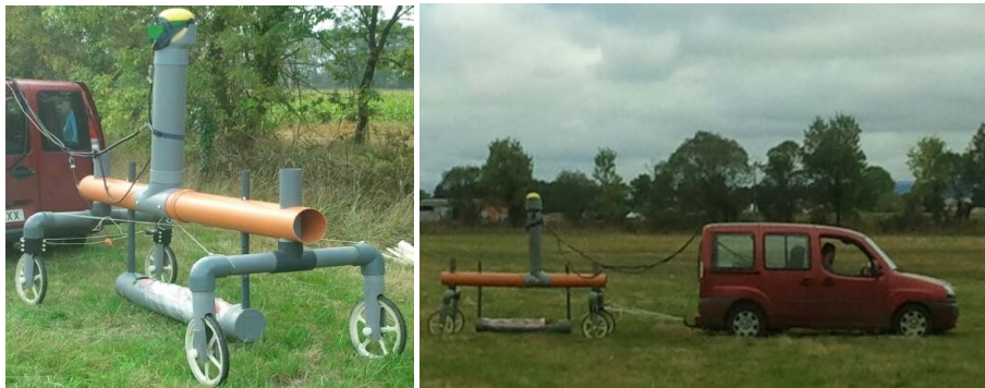
Figura 2.6. Equipo de medida de la conductividad eléctrica aparente del suelo.
