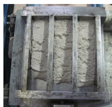
Imagen 5-3: Mortero avanzando por el efecto de las sacudidas de la compactadora
