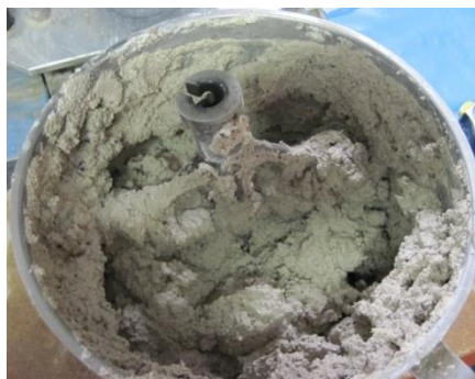
Imagen 4-9: MK75 (cal:arena en volumen de conjunto = 1:2 y agua/cal en masa 1.7)
