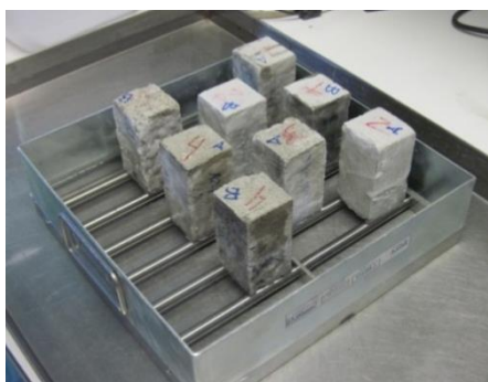
Imagen 5-20: Probetas con la sección de corte sumergida, apoyadas en un tamiz de barras. El agua está contenida en una bandeja.
