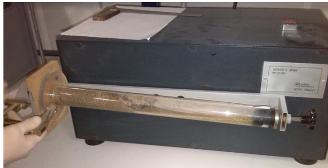
Imagen 3-47: Probeta colocada en máquina de agitación
