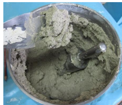
Imagen 4-10: MK100 (cal:arena en volumen de conjunto = 1:2 y agua/cal en masa 1.7)
