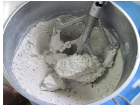
Imagen 4-8: Mortero de cal con relación cal:arena en volumen de conjunto = 1:2 y relación agua/cal en masa = 1.5
