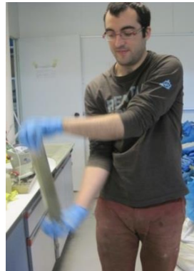
Imagen 5-8: Inversión del picnómetro. Este movimiento se repite 20 veces para conseguir la dispersión del mortero en la mezcla agua-alcohol.
