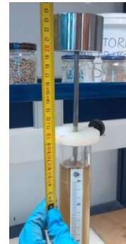
Imagen 3-46: Medida del pisón a la parte superior de la probeta
