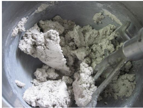
Imagen 4-7: Mortero de cal con relación cal:arena en volumen de conjunto = 1:2 y relación agua/cal en masa = 1.3
