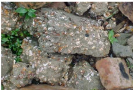
Imagen 2-25: Escombros de hormigón con bígaro como árido grueso
