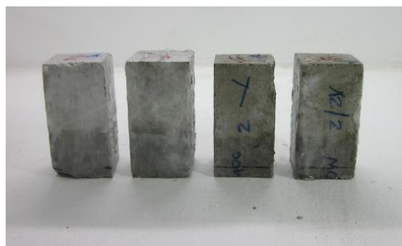
Imagen 5-21: Probetas tras ensayo de capilaridad (las de la izquierda MC0, las de la derecha MC100)
