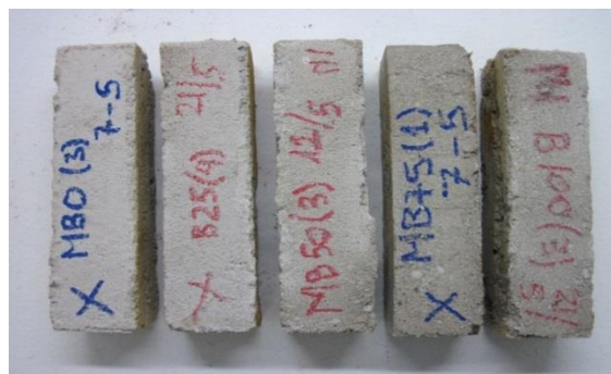
Imagen 4-12: Probetas de mortero de barro con distintos ratios de sustitución (0 a 100% de izquierda a derecha)
