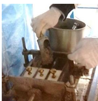
Imagen 5-1: Vertido de mortero en molde
