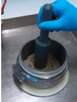
Imagen 5-4: Compactación del mortero con pisón.
