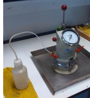
Imagen 5-6: Medidor de contenido en aire con pipeta llena de agua conectada a una de sus válvulas.
