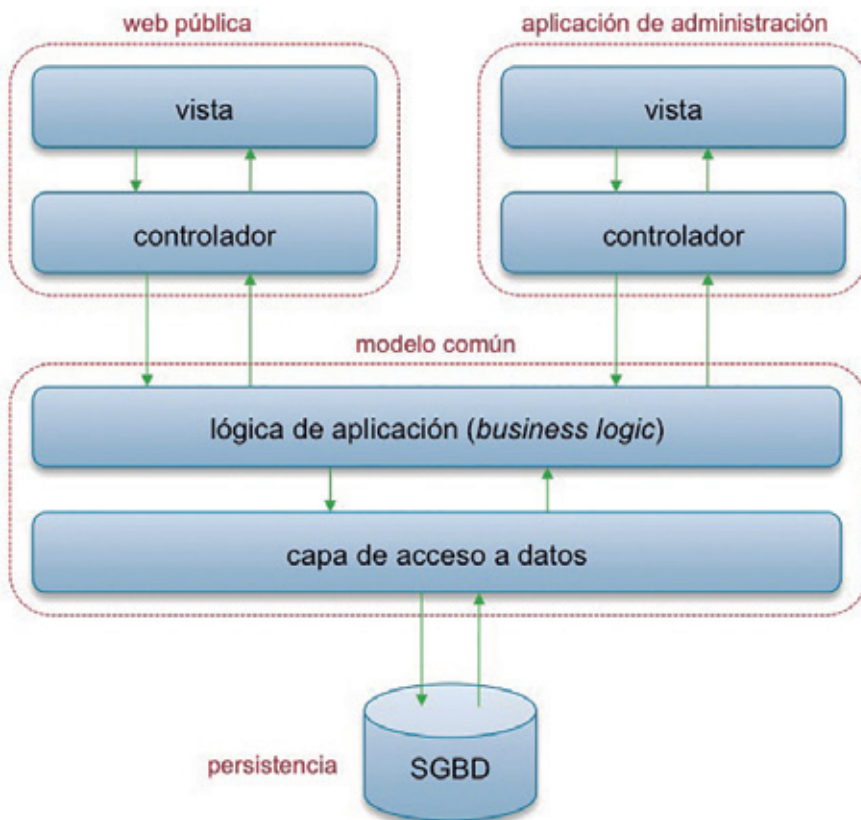
Fig. 4. Arquitectura de aplicaciones.
