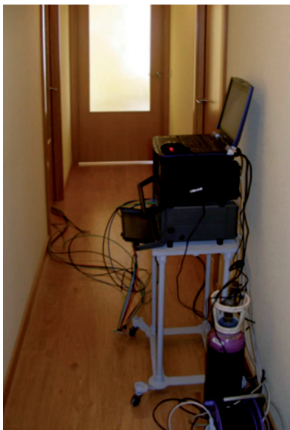
9 (Imagen doble arriba) Condiciones de realización del ensayo de presurización por ventilador en vivienda de la urbanización Zabalgana 10 (Imagen doble abajo) Ensayo con gases trazadores en una vivienda en una vivienda de la urbanización Zabalgana
