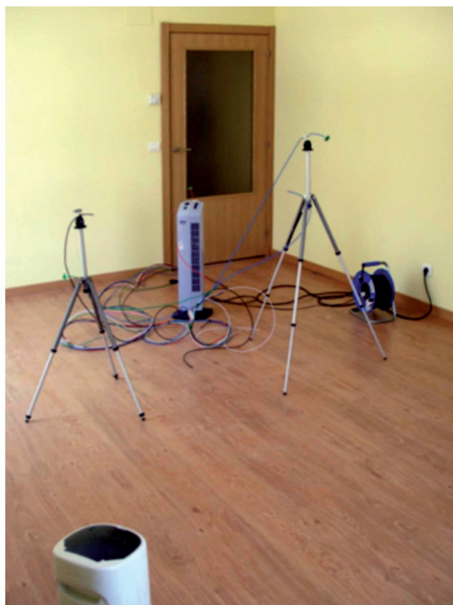
9 (Imagen doble arriba) Condiciones de realización del ensayo de presurización por ventilador en vivienda de la urbanización Zabalgana 10 (Imagen doble abajo) Ensayo con gases trazadores en una vivienda en una vivienda de la urbanización Zabalgana
