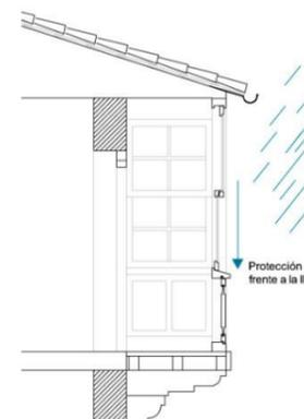
10 Comparación entre la incidencia de la lluvia en un muro de piedra y la protección que supone la introducción de la galería.
