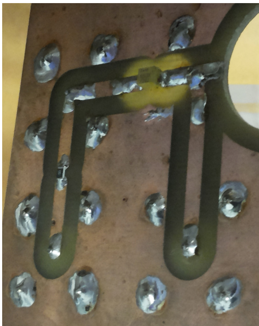
Ilustración 36 Circuito utilizado para el cálculo de la inductancia real de las bobinas
