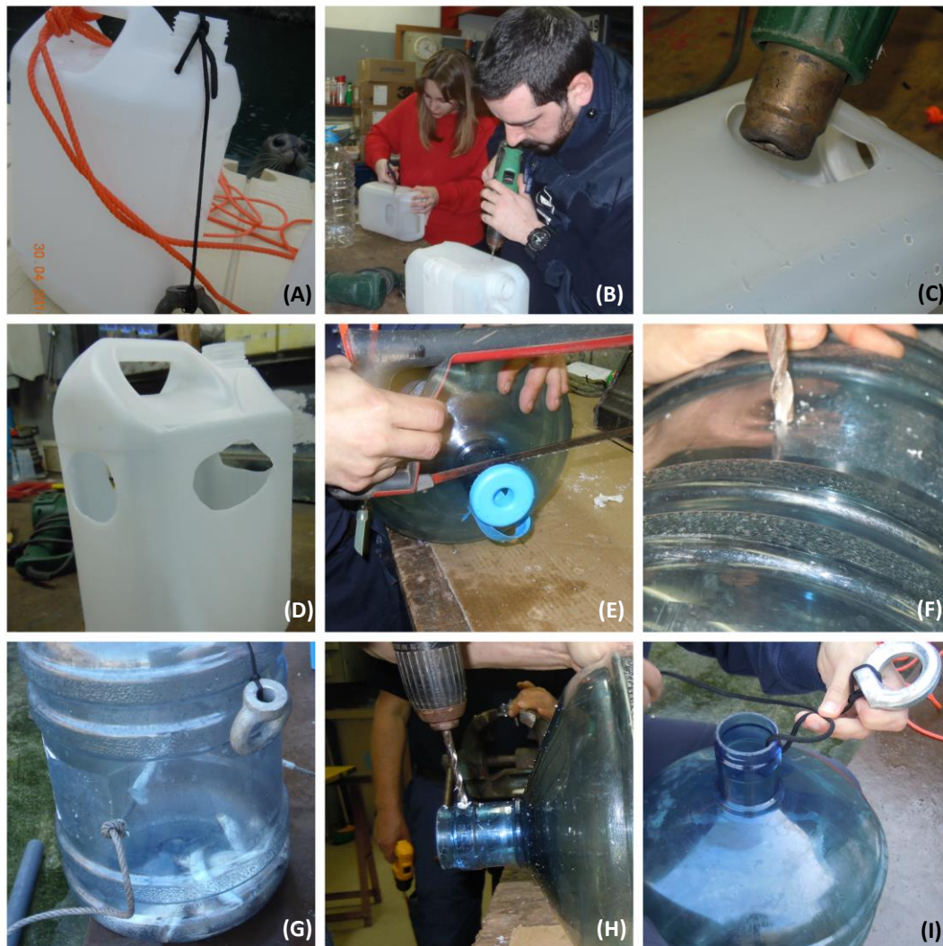
Figura 6. (A) Colocación del peso en el bidón opaco. (B) Proceso de fabricación de los bidones opacos agujereados. (C) Utilización del soplete para alisar los cortes de los agujeros de los bidones opacos agujereados. (D) Bidón opaco agujereado tras su fabricación con sus cuatro agujeros situados alrededor de la boquilla. (E) Utilización de la sierra para eliminar el tapón del bidón transparente. (F) Utilización del taladro para realizar dos agujeros en la zona media del bidón. (G) Resultado de la realización de los agujeros anteriores: cuerda que atraviesa el bidón facilitando su sujeción. (H) Realización de un agujero en la boquilla de los bidones transparentes. (I) Colocación del peso en el bidón transparente.
