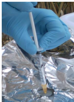
Figura 2.11. Sistema de toma de mostra a través do septo.
