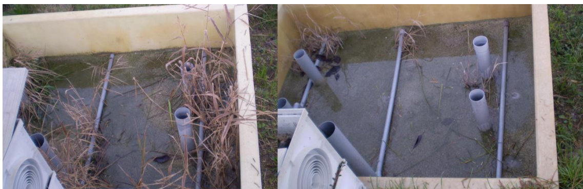
Figura 5.11. Estancamento da auga (trala adición de area en superficie) posterior á descarga do sifón nos dous humidais verticais.
