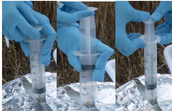
Figura 2.10. Sistema de homoxenización previa á toma de mostra a través do septo.
