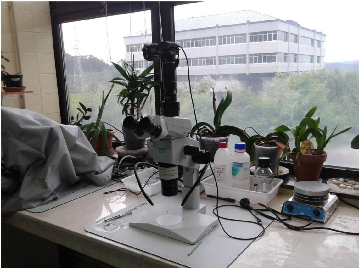
Figura2. Cámara fotográfica conectada a una lupa mediante la cual se obtuvieron las fotografías.
