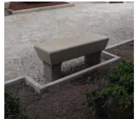
Fig. 269. Banco no accesible (fuente propia)
