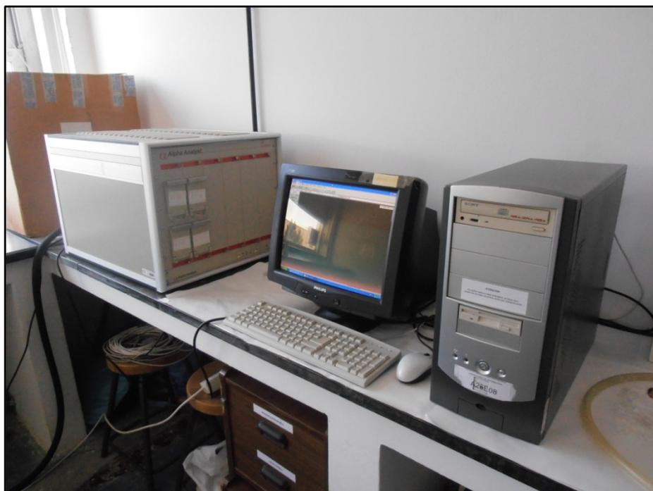
Figura 25. Espectrómetro alfa modelo Alpha Analyst de la casa Canberra™
