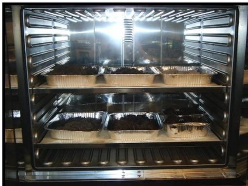
**Figura 24. Secado de la muestra de suelo en estufa**
