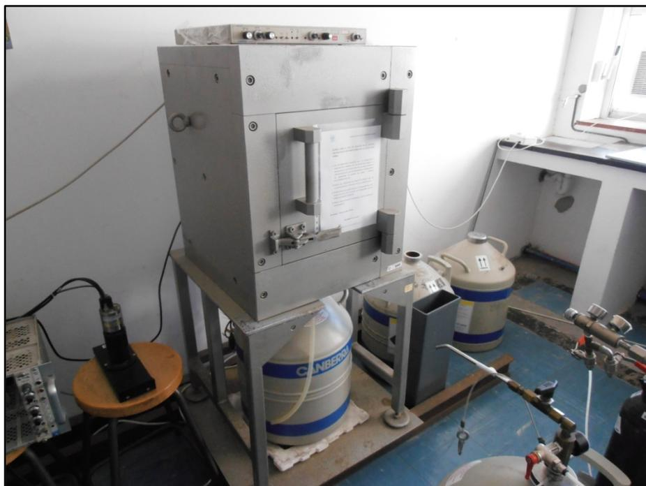
**Figura 26. Espectrómetro gamma Canberra™ modelo GX6020**
