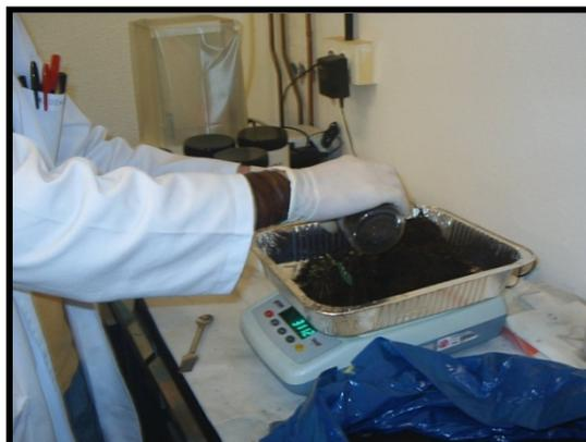
**Figura 23. Pesada de las muestras de suelo en bandeja de aluminio.**
