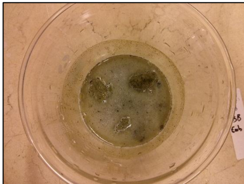
Muestra: B3_2 Material con H_2O_2 por el tamiz de 0,2 mm.
