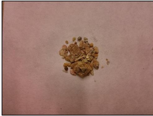
COD: 07_1 Material retenido en tamiz de 2 mm.
