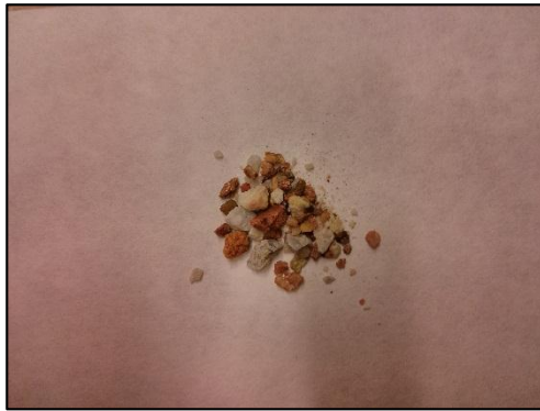
COD: 11_2 Material retenido en tamiz de 2 mm.
