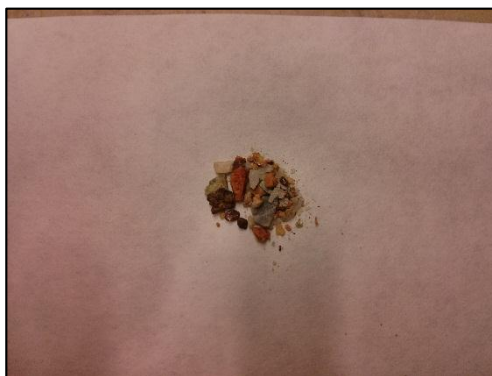
COD: 11_1 Material retenido en tamiz de 2 mm.
