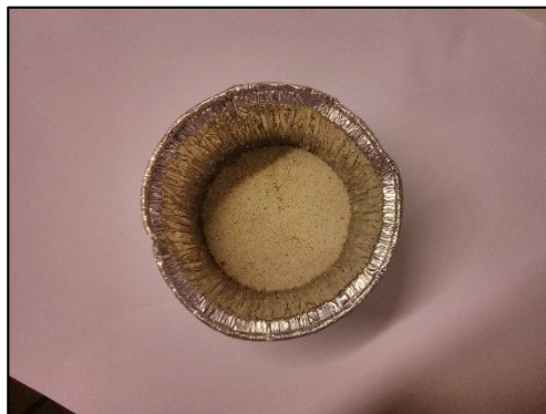
COD: CF_1 Material retenido en tamiz 0,05 mm.
