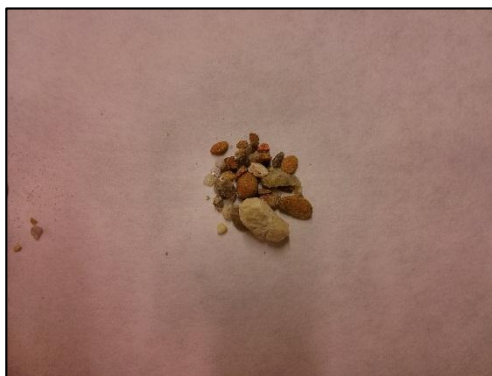
COD: 07_2 Material retenido en tamiz de 2 mm.
