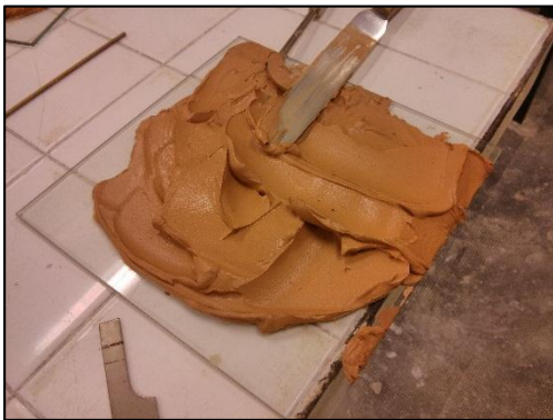
Se homogeniza la muestra antes de empezar con el ensayo.
