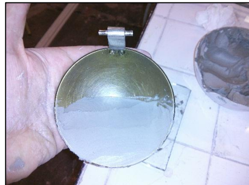
Se coloca en la zona donde la cuchara descansa sobre su base una porción de suelo amasado, aplastándola hacia abajo, de manera que el material tenga una altura de unos 10mm.
