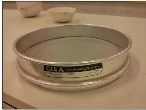
Se pasa el material por el tamiz de 0,4 mm y nos quedamos con el material que pasa.
