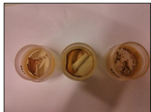
COD: CF_1 Material extraído en alícuotas correspondientes a T=0, T=1, T=2. (de izquierda a derecha).
