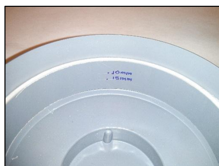
Marcado del nivel mínimo y máximo de la saturación según norma EN-1015-19
