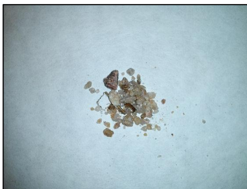
COD: 31_2 Material retenido en tamiz de 2 mm.
