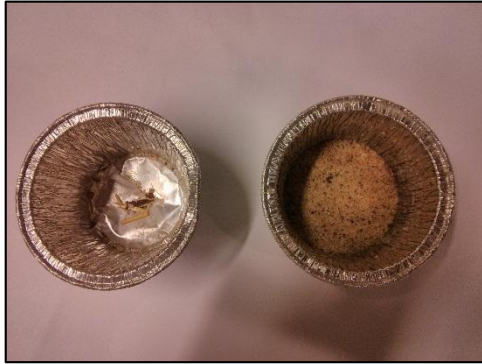
COD: EmB_1 Material retenido en tamiz 2 y 0,05 mm. (de izquierda a derecha).
