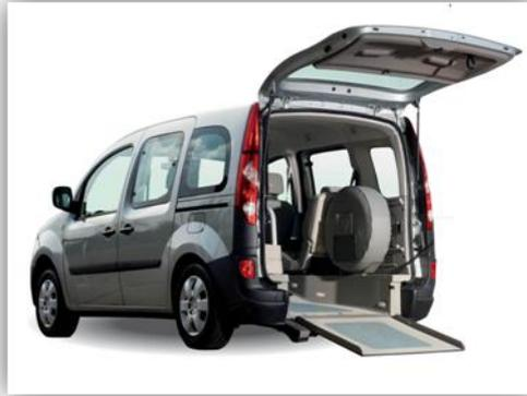
**Imagen 9: Automóvil particular con adaptación para silla de ruedas eléctrica**
