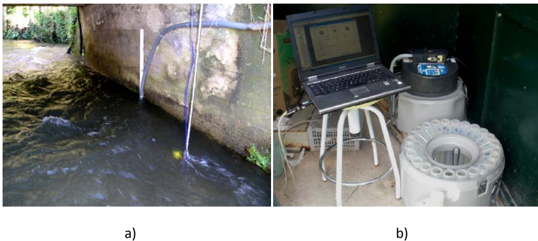
Figura 5.3. Estación de aforo. a) Situación del sensor de presión. b) Muestreador automático modelo ISCO 6720.
