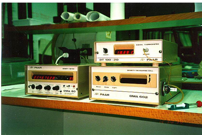
**Figura 4.1.**-Componentes del densímetro
