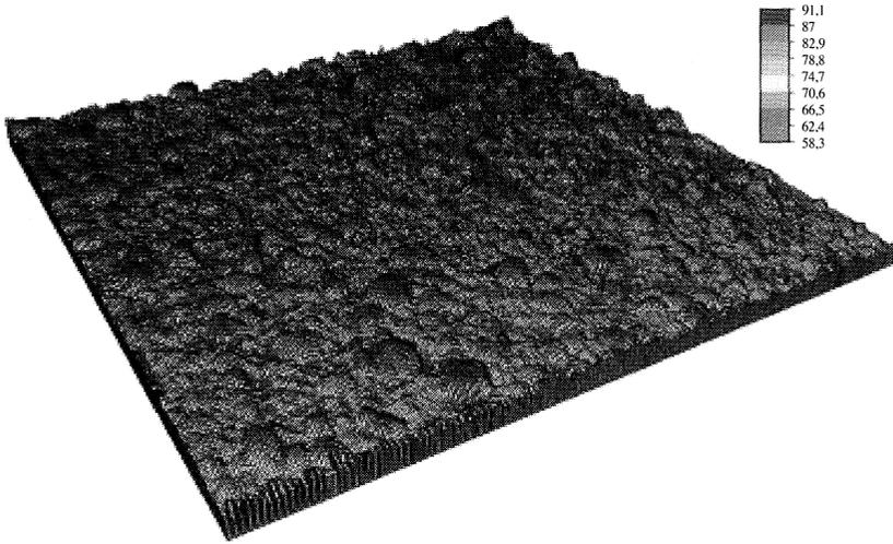
Figura 4. Mapa de elevación digital de la superficie de un suelo agrícola (cotas en mm).
