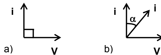
Fig. 1.4: Diferenza de fase entre i e V : a) nun dieléctrico ideal ( 90^\circ ). b) nun dieléctrico real ( 90-\alpha ).
