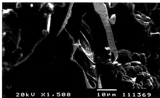
Figura 3 Imagen de la estructura de la caliza de Hontoria vista en el microscopio electrónico de barrido 1.500 veces ampliada
