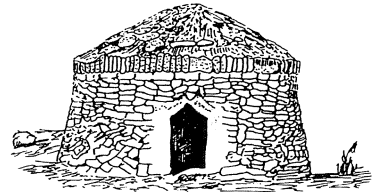
Barraca del Bosc Vall (Palma, Mallorca). Es de planta circular y está techada con piedra y tierra.
