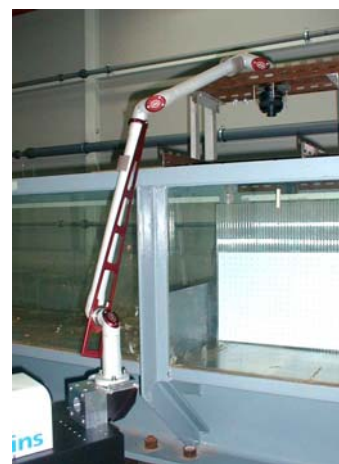
Fotografía 5.2. Detalles de la fuente láser y brazo articulado del PIV
