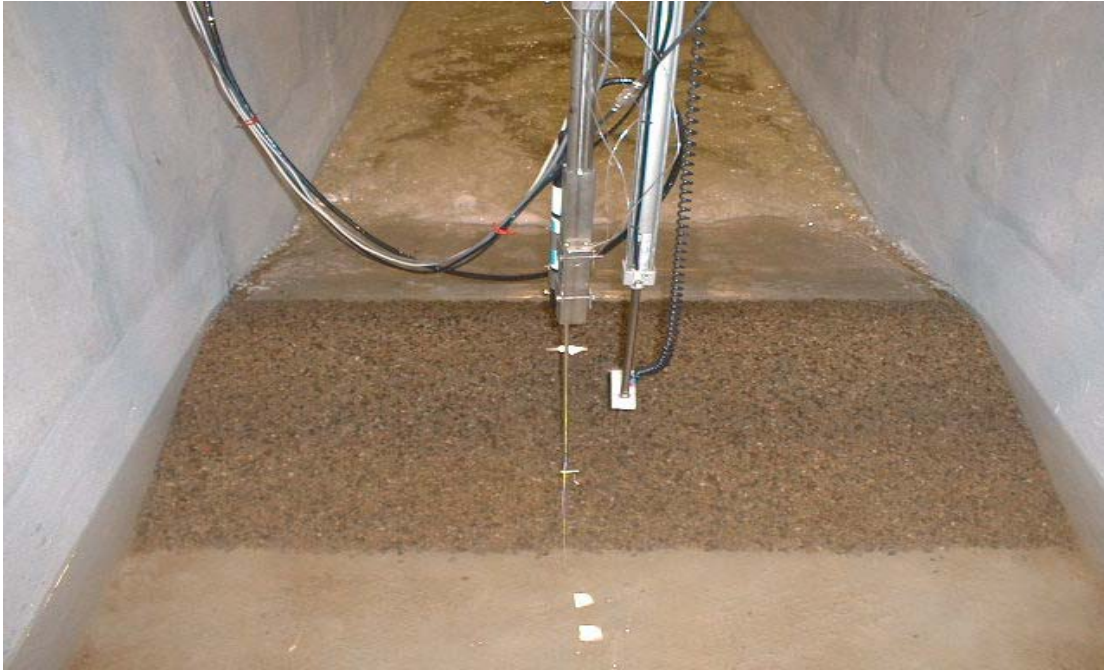
Fotografía 5.14. Detalle del velocímetro ADV y el aparato de medida de calados, durante uno de los ensayos en el CITEEC
