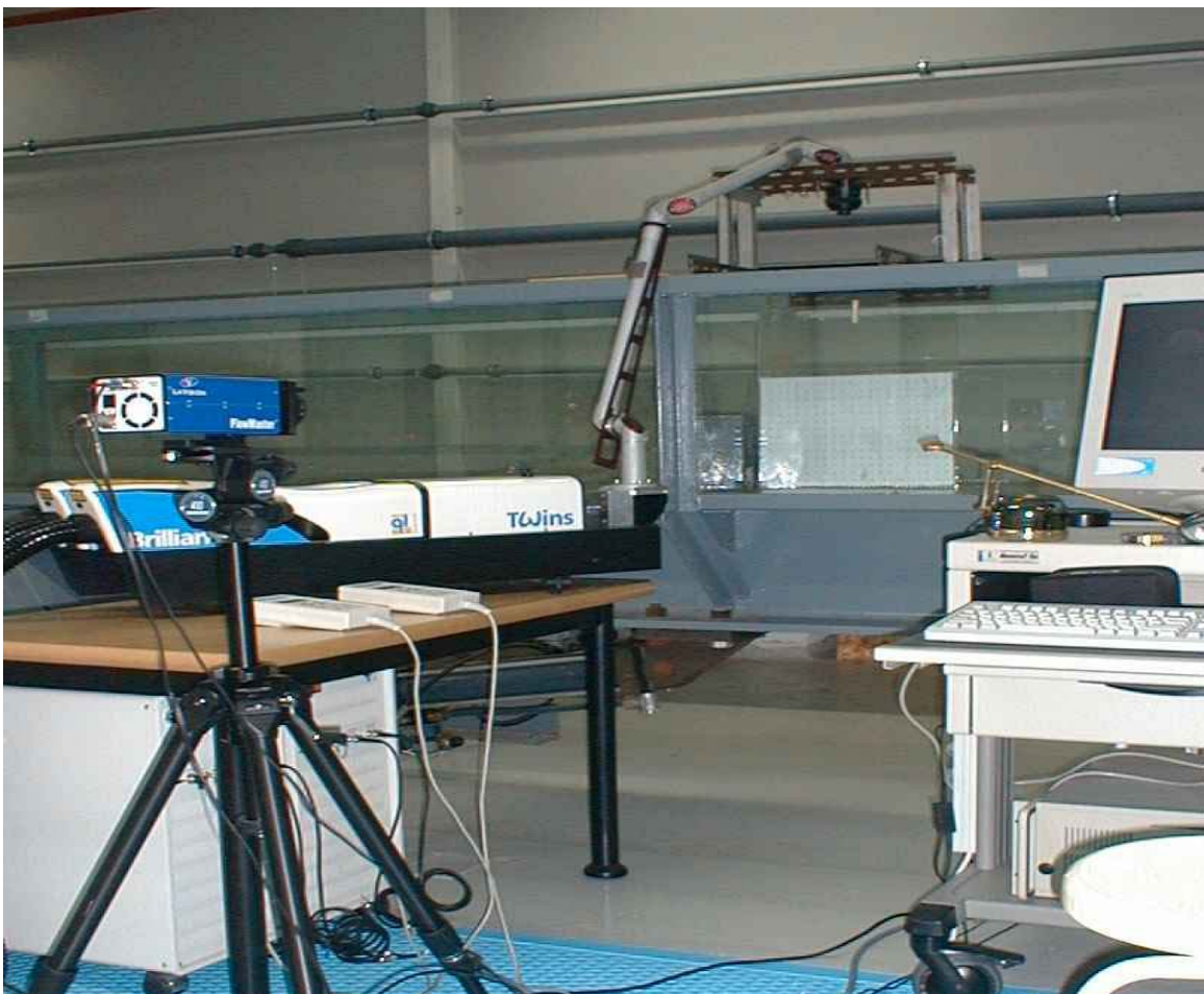
Fotografía 1.1. Montaje experimental del PIV en el canal de ensayos del Laboratorio de Hidráulica de la Escuela Técnica Superior de Ingenieros de Caminos, Canales y Puertos
