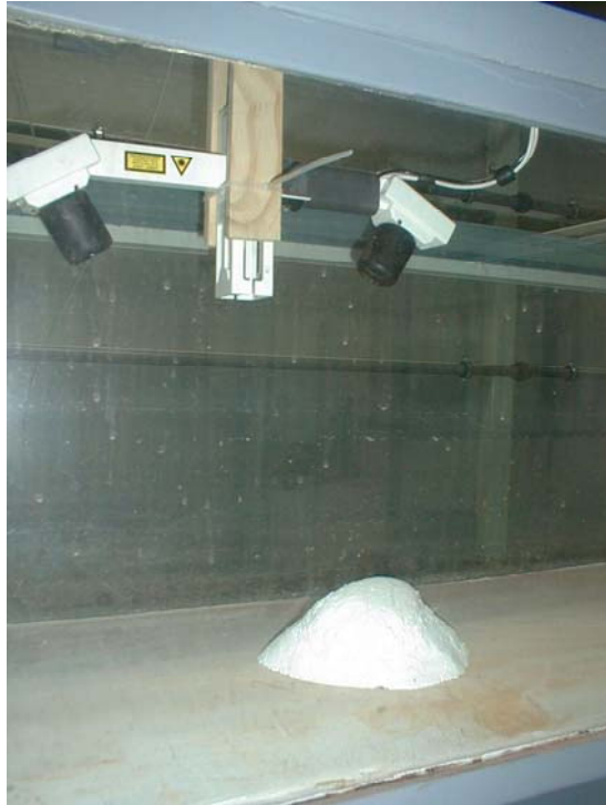
Fotografía 5.6. Ensayo de medición de un objeto con el Scanner 3D
