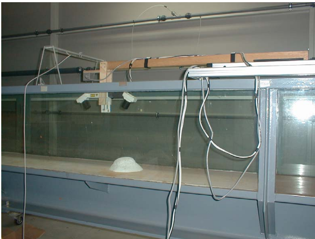
Fotografía 5.5. Colocación del equipo en el canal de ensayos para la medición de un objeto y evaluar la influencia de la refracción
