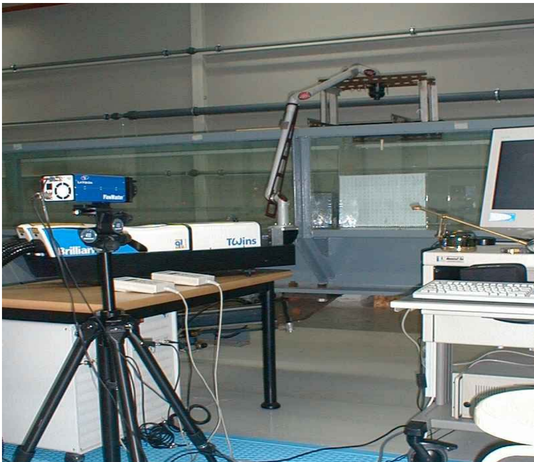
Fotografía 5.1. Montaje experimental del trabajo con PIV en el canal de ensayos del Laboratorio de Hidráulica de la Escuela Técnica Superior de Ingenieros de Caminos, Canales y Puertos
