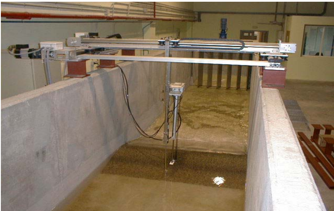
Fotografía 5.13. Canal de ensayos del CITEEC con el posicionador unido a la instrumentación
