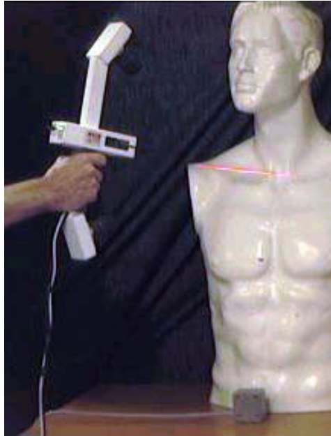
Fotografía 5.4. Emisor láser, cámaras y elemento de referencia del Scanner 3D
