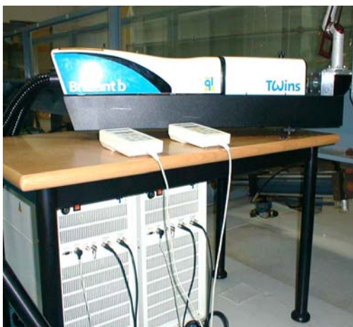
Fotografía 5.2. Detalles de la fuente láser y brazo articulado del PIV
