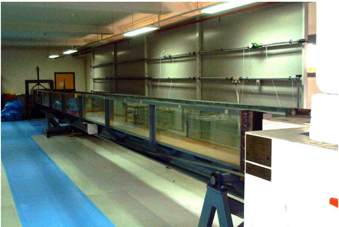
Fotografía 5.9. Canal de ensayos del Laboratorio de Hidráulica de la Escuela Técnica Superior de Ingenieros de Caminos, Canales y Puertos
