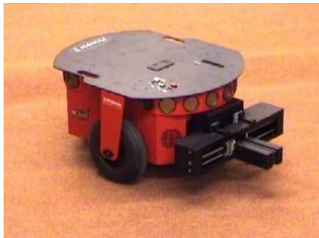
Figura 67. Imagen del robot Pioneer 2 con la pinza (gripper) que utilizaremos en el ejemplo.
