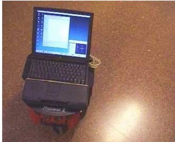
Figura 66. Robot Pioneer 2 llevando el ordenador portátil donde se ejecuta el MDB.
