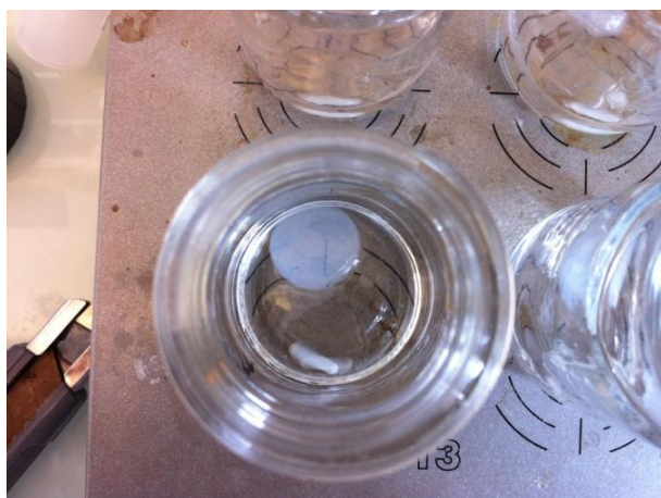
Figura 2.12. Prueba en batch de adsorción de plomo sobre el material compuesto sílice/HAp.
