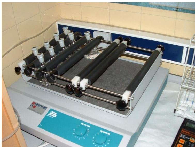
Figura 2.6. Agitador orbital con muestras para el barrido de materiales
