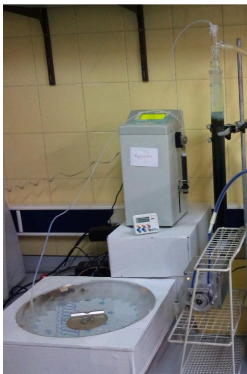
Figura 2.9. Dispositivo experimental de los estudios en continuo. Incluye la columna, el muestreador automático y la bomba peristáltica.
