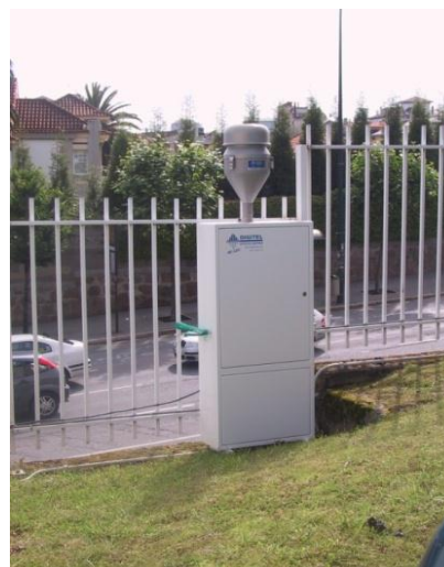
Figura 3.4. Captador gravimétrico en A Coruña
