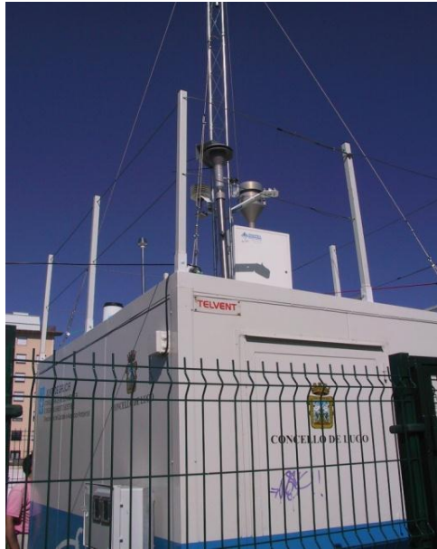
Figura 3.8. Captador gravimétrico en Lugo durante el periodo cálido
