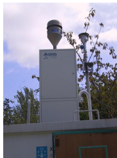
Figura 3.11. Captador gravimétrico en Ferrol
