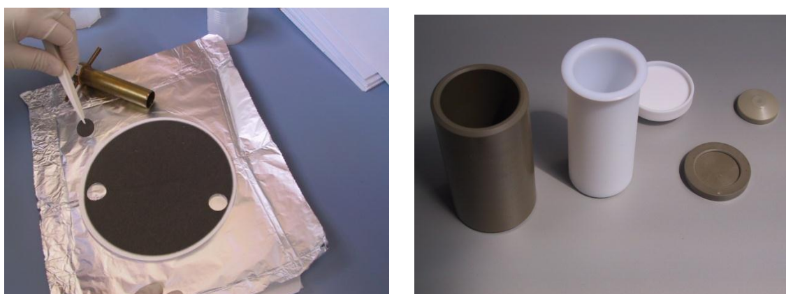
Figura 3.17. Corte de alícuotas de filtros y reactores de teflón (TFM)
