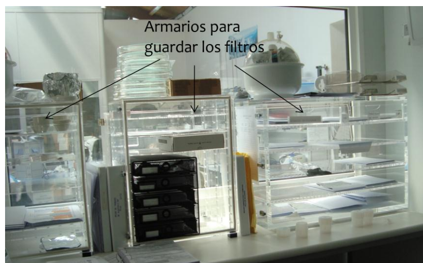
Figura 3.14. Armarios para guardar filtros dentro de la sala de balanzas del IUMA
