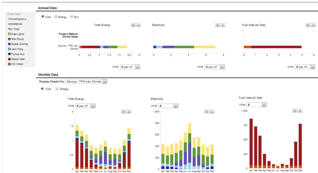
Ilustración 33 – Consumo anual y mensual de energía para el modelo de información de la Villa Savoye creado para este TFG. Fuente: https://gbs.autodesk.com/
