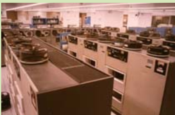
◀ Els discos IBM 3330 amb unitats de cinta 3803, de 100 a 200 Mb de capacitat c. 1982.
