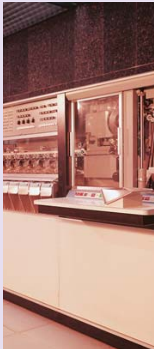
▲ Lectora classificadora magnètica de documents IBM 1412. Per a la compensació de xecs, va gaudir d'una gran acceptació en la banca nord-americana. Malgrat provar-la durant un temps, la CPVE la va refusar perquè no s'adaptava a la seva operativa corrent.
