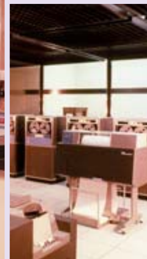
◀ En primer pla, la lectora perforadora IBM 1402-2, i en el centre de la imatge, la impressora, al fons, les cintes magnètiques.
