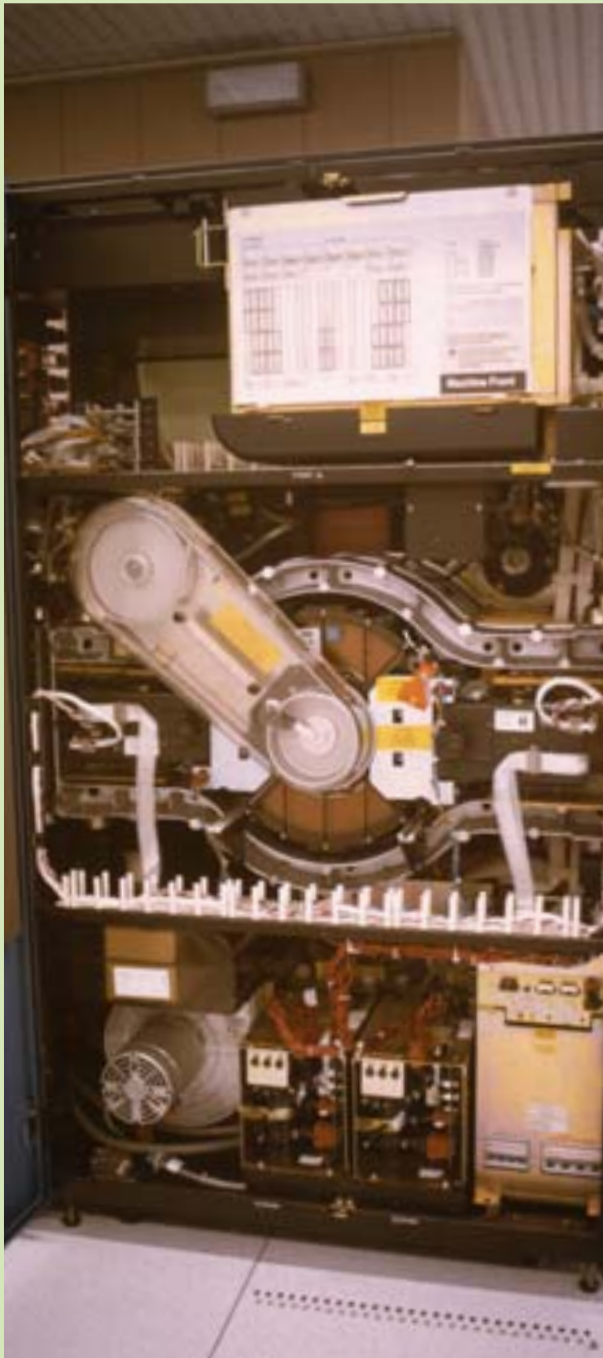
◀ Les entranyes del disc fix IBM 3380, dues unitats per armari (c. 1986-1992).
