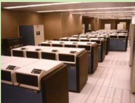
◀ Discos fixos IBM 3350 amb una capacitat entre 600 i 1200 MB. Van ser els primers discos fixos, és a dir, no desmuntables. Una fila de 8 discos d'aquestes característiques tenia la capacitat d'un pendrive actual, que costa cinc euros. El disc fix permetia treballar amb toleràncies més estrictes i, sobretot, feia possible que la unitat estigués hermètica i l'aïllava de possibles contaminacions.
