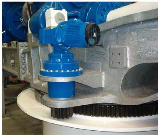
Figura 1.13. Motorreductor de giro góndola.
