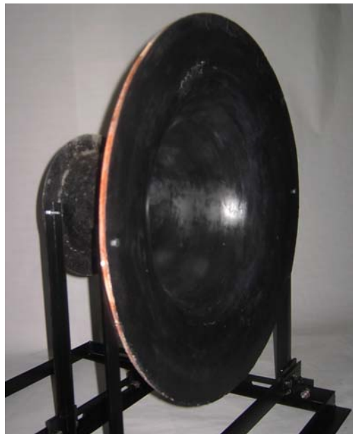
Figure 3.16. Fabricación del concentrador eólico.
