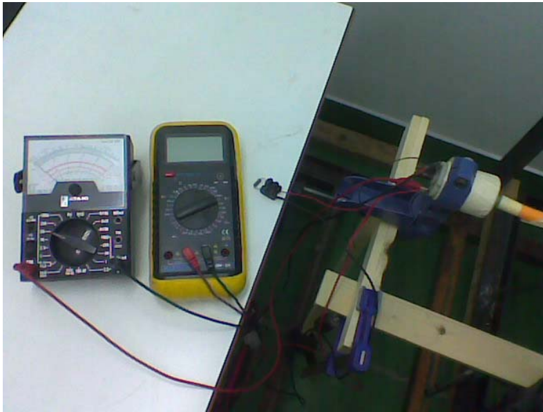
Figura A.2.25. Disposición de voltímetro, amperímetro, resistencia eléctrica y generador en el banco de pruebas.
