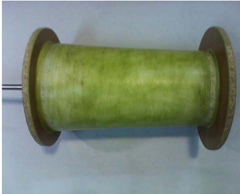
Figura 2.10. Molde del difusor terminado y encerado.
