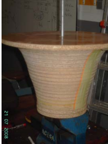
Figura 2.2. Disposición de discos y separadores para la obtención del molde concentrador.
