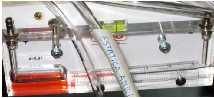
Figura 3.13. Manómetro de columna inclinada (0 – 50 Pa).
