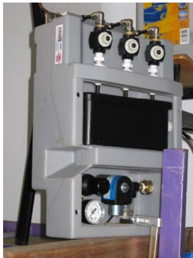
Figura 3.10. Humidificador adiabático con boquillas atomizadoras.
