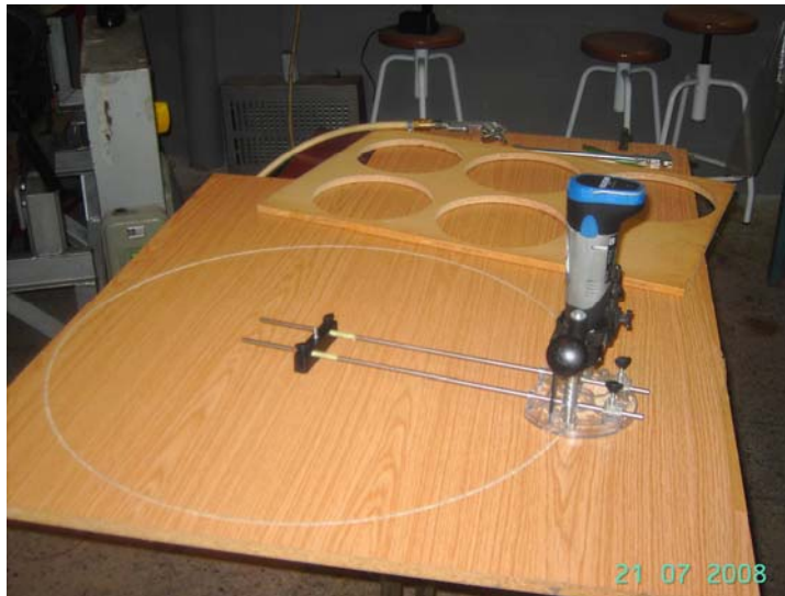
Figura 2.1. Fresado de las secciones de paso del molde.
