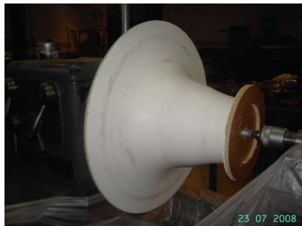
Figura 2.5. Aspecto final del molde una vez lijado.
