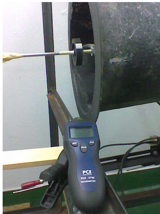
Figura A.2.21. Disposición del tacómetro digital PCE Ibérica Modelo DT62.
