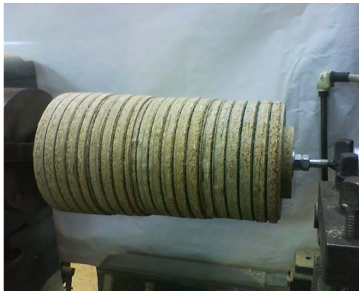
Figura 2.9. Marcado de los diámetros de referencia en el torno paralelo.
