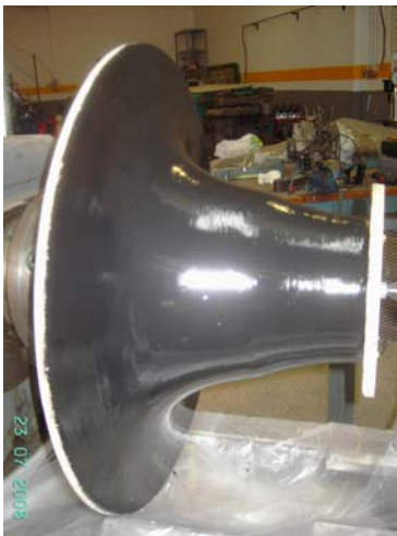
Figura 2.6. Aplicación de gel-coat sobre la superficie del molde
