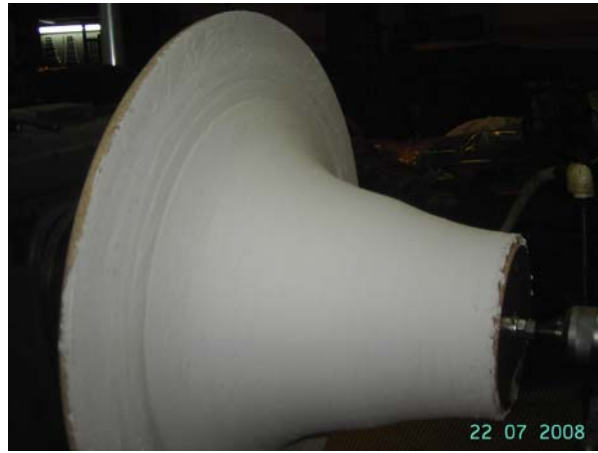
Figura 2.4. Emplastecido de la superficie del molde.
