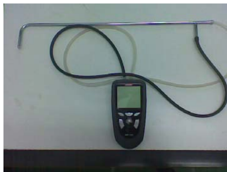
Figura A.2.18. Tubo pitot conectado al manómetro de presión diferencial.
