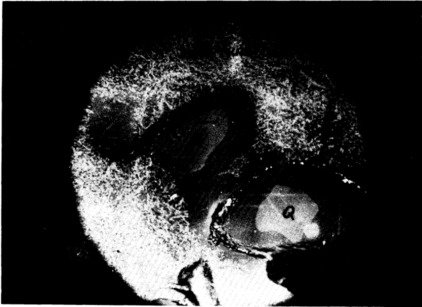
Fig. 7.20. Muestra IGN cocida a 1400^{\circ}\text{C}/2 horas. Mostrando dos granos de cuarzo en disolución alrededor de los cuales se han generado grietas y una zona alta en sílice, donde la disolución ha sido completa. Se puede observar la mullitización del resto del material. Ataque FH vapor (x 650).
