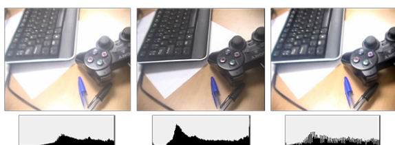
Figura 5: Oscurecido de imagen. De izq. a dcha.: imagen original, cálculo de la media, ecualización de histograma
