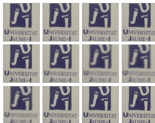
Figura 6: Transición en el proceso de enfoque automático
