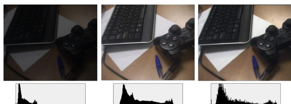
Figura 4: Aclarado de imagen. De izq. a dcha.: imagen original, cálculo de la media, ecualización de histograma
