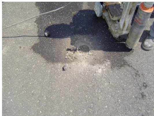
Figura 8. Intento fallido de extracción de un testigo
